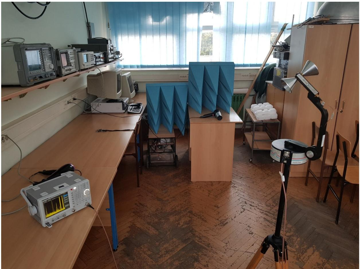
*Slika P.2.: Mjerenje EM zračenja u laboratoriju za VF mjerena na Fakultetu elektrotehnike, računarstva i informacijskih tehnologija Osijek*
