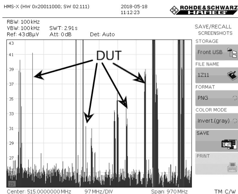
*Slika 3.2. Amplitude signala s uključenim uređajem*
