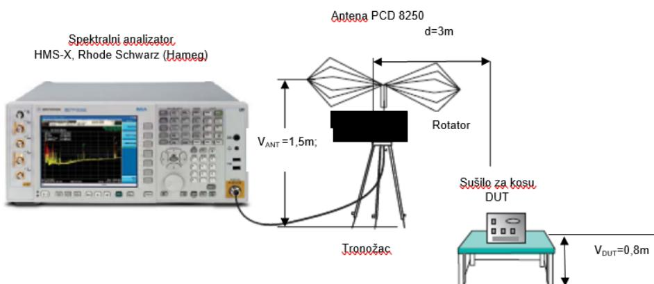
**Slika 3.15.** Shema mjerenja jakosti električnog polja (amplitud signala) DUT-a. [26]
