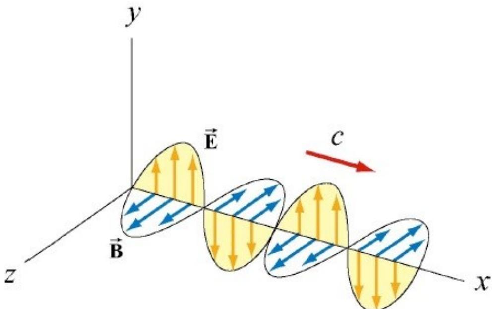
*Slika 2.1. Nastajanje elektromagnetskog vala [5]*
