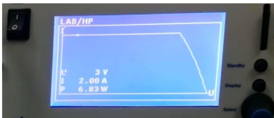
Slika 4.5. Položaj radne točke na početku za vrijeme 1 minute izvršenja karakteristike zasjenjenja
