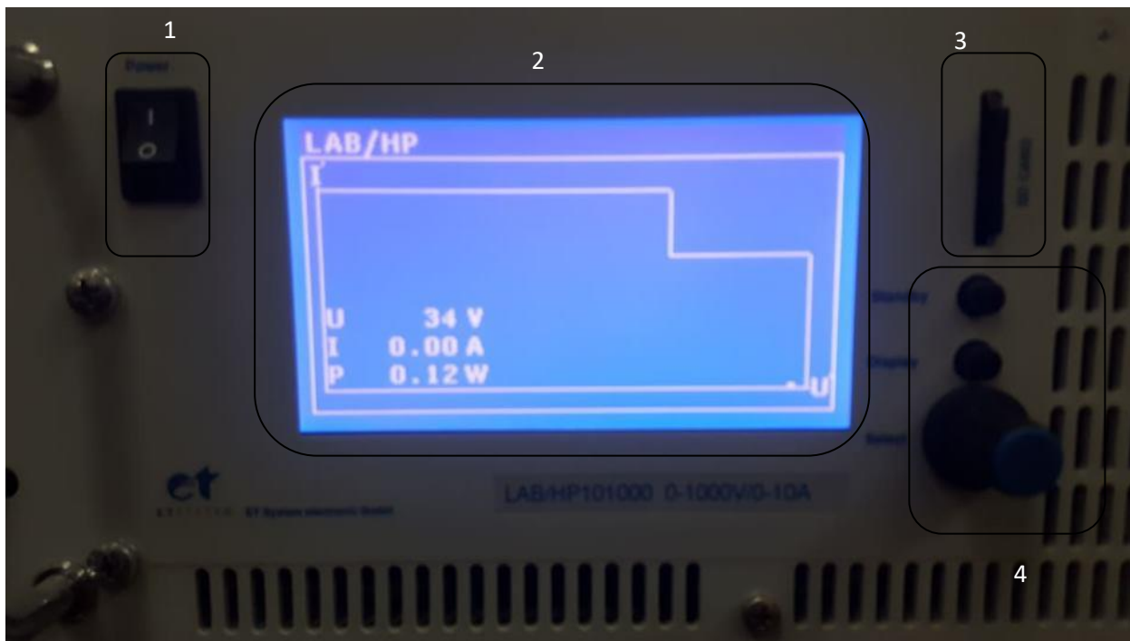
Slika 2.3. Prikaz prednje upravljačke ploče istosmjernog izvora
