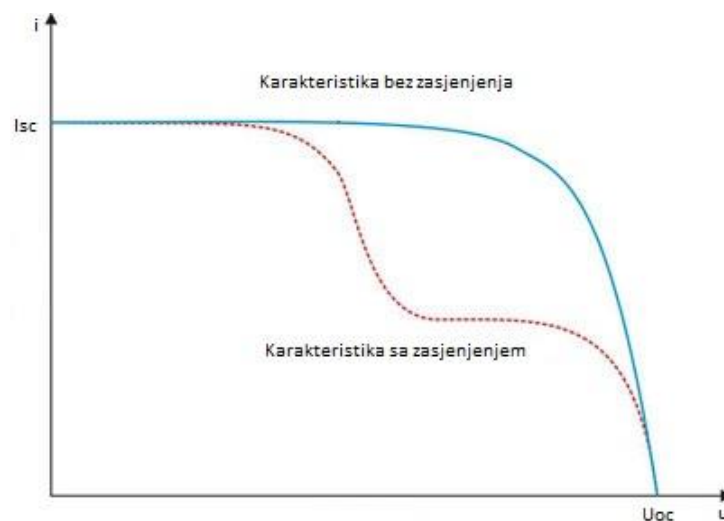
Slika 4.1. Karakteristike modula bez zasjenjenja i sa zasjenjenjem
