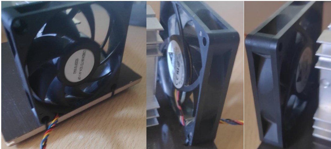
Slike 3.19., 3.20. i 3.21. Fizička montaža prijenosnika topline
