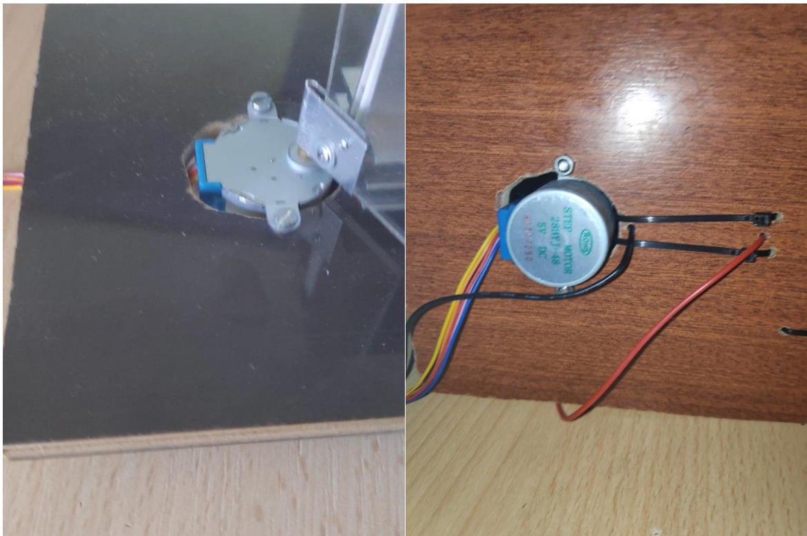
Slike 3.7. i 3.8. Fizička montaža koračnog motora
