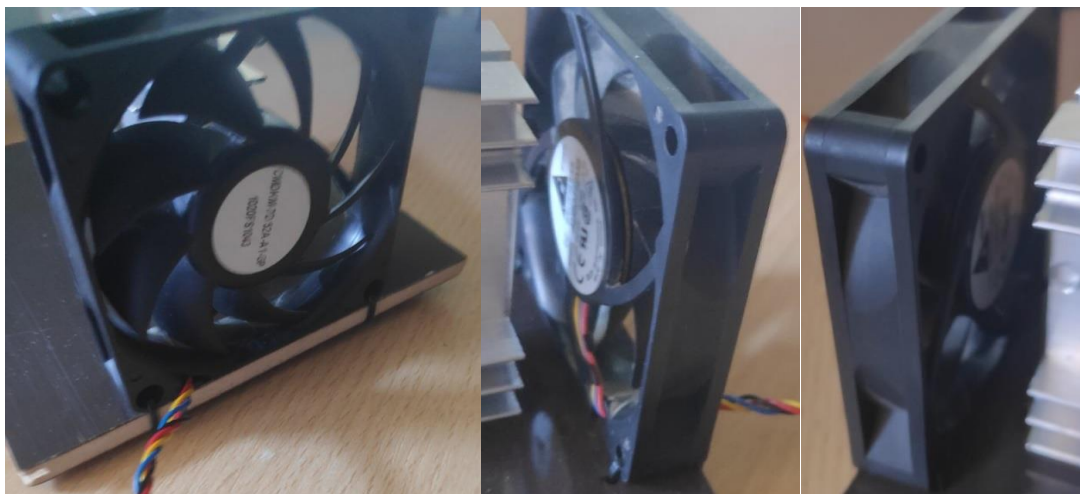
Slike 3.19., 3.20. i 3.21. Fizička montaža prijenosnika topline
