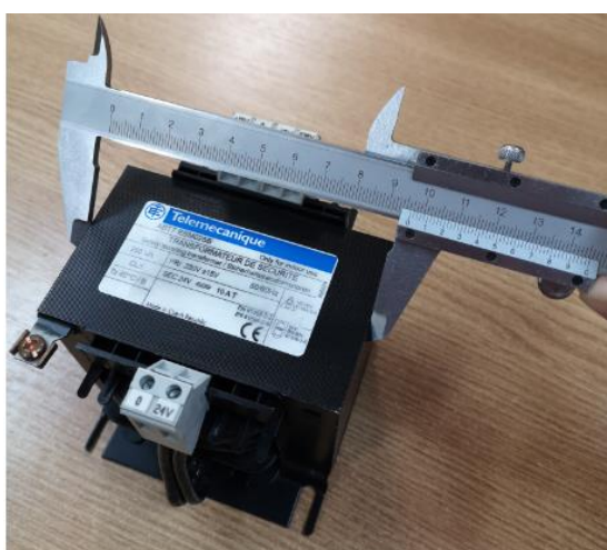
Slika 4.1 Mjerenje dimenzija površina transformatora
