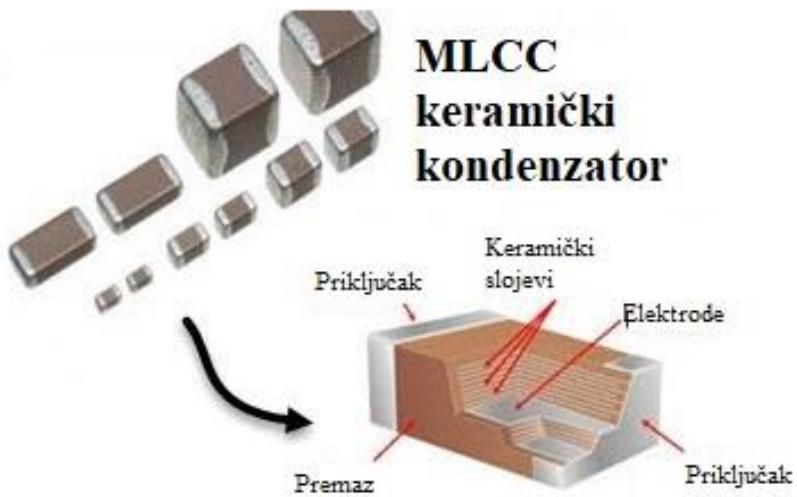
**Sl.4.4.** Višeslojni keramički kondenzator
