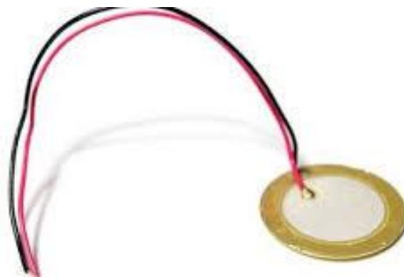
Sl.4.10. Piezoelektrični generator [17]
