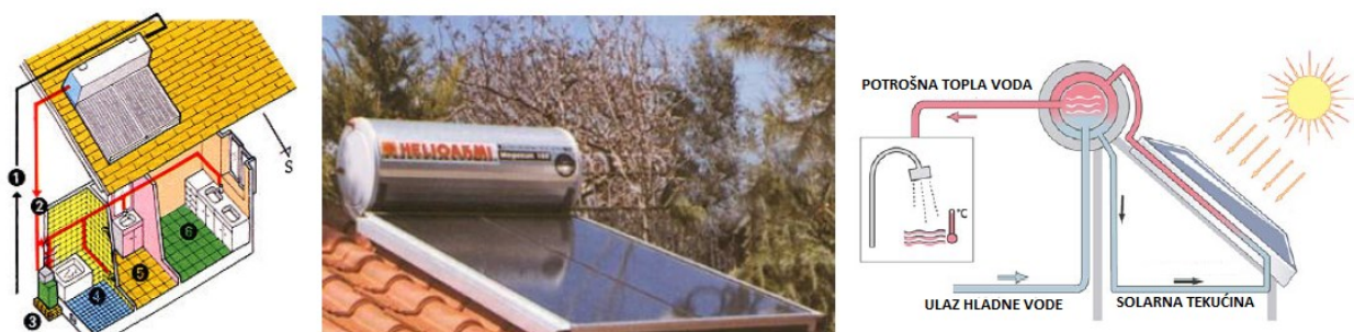
Slika 3.1. Primjer sustava s prirodnom cirkulacijom [2]
