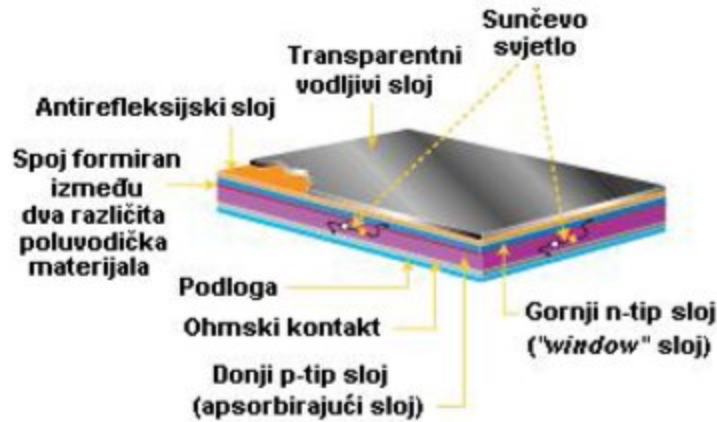
Slika 4.4. Struktura polikristalne tankoslojne FN ćelije [5]
