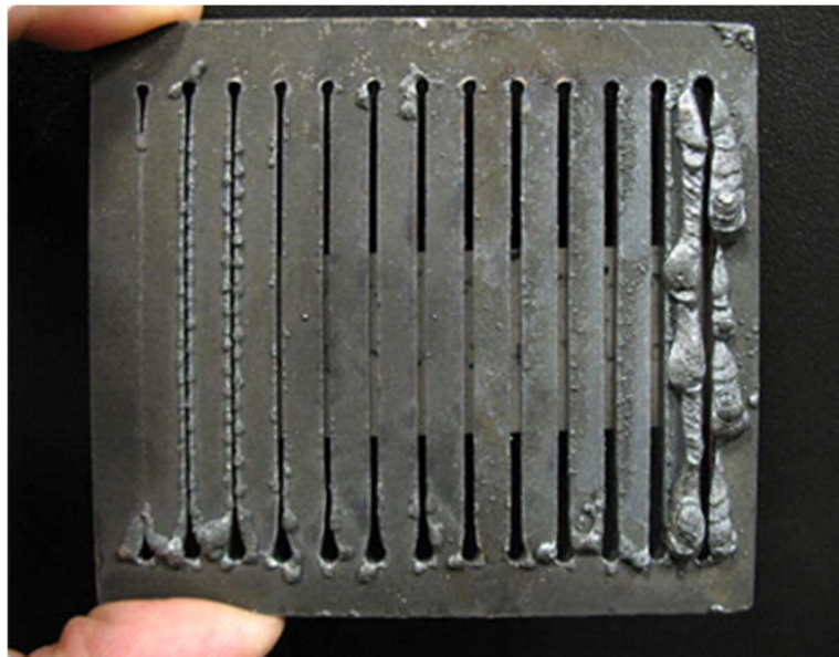
Slika 1.1. Rezovi dobiveni različitim visinama elektrode [2]
