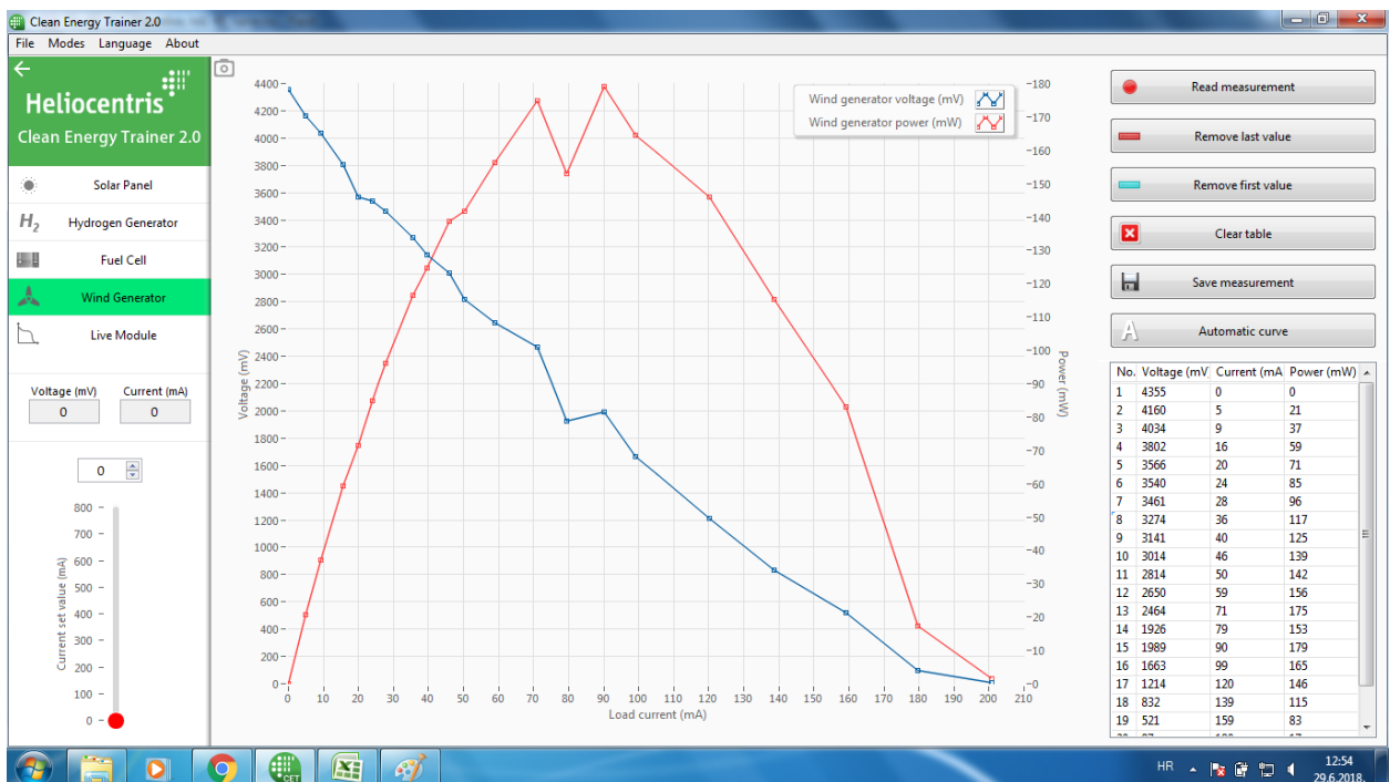
Slika 4.4. 3 lopatice, 45° prema osovini, snaga vjetra ventilatora 2
