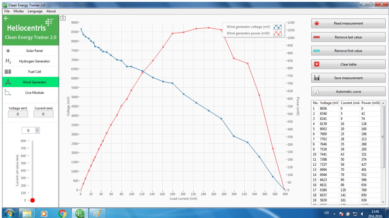
Slika 4.7. 6 lopatica, 60° prema osovini, snaga vjetra ventilatora 2
