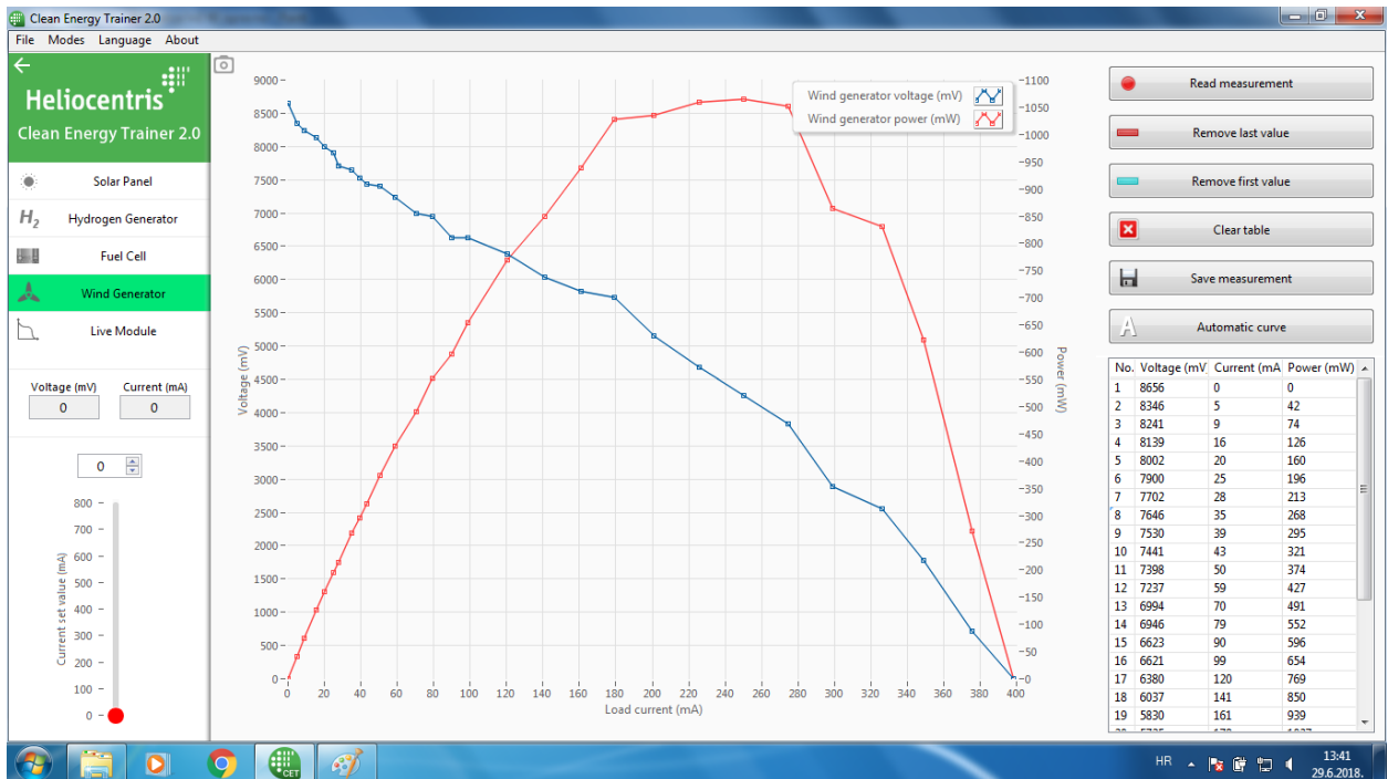
Slika 4.7. 6 lopatica, 60° prema osovini, snaga vjetra ventilatora 2
