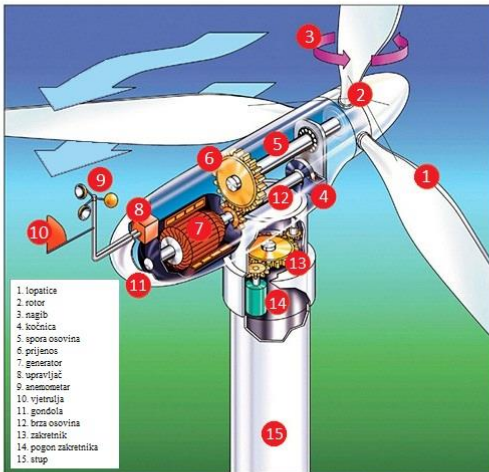
Slika 2.4. Dijelovi vjetroturbine
