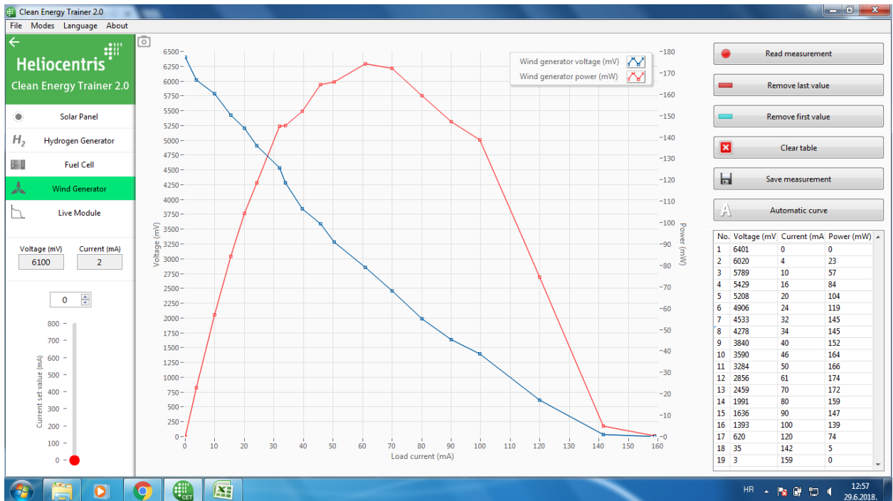
Slika 4.5. 3 lopatice, 60° prema osovini, snaga vjetro ventilatora 2
