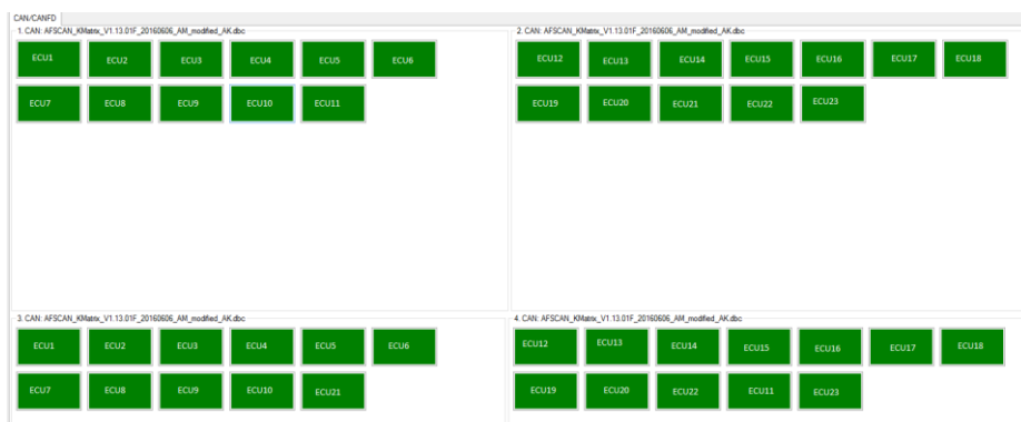
Sl. 3.2. TTX Connexion Configurator sučelje za dodavanje ECU-ova
