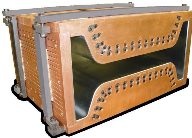
Sl. 2.9. Bakreni kalup (kokila) za kontinuirano lijevanje.
