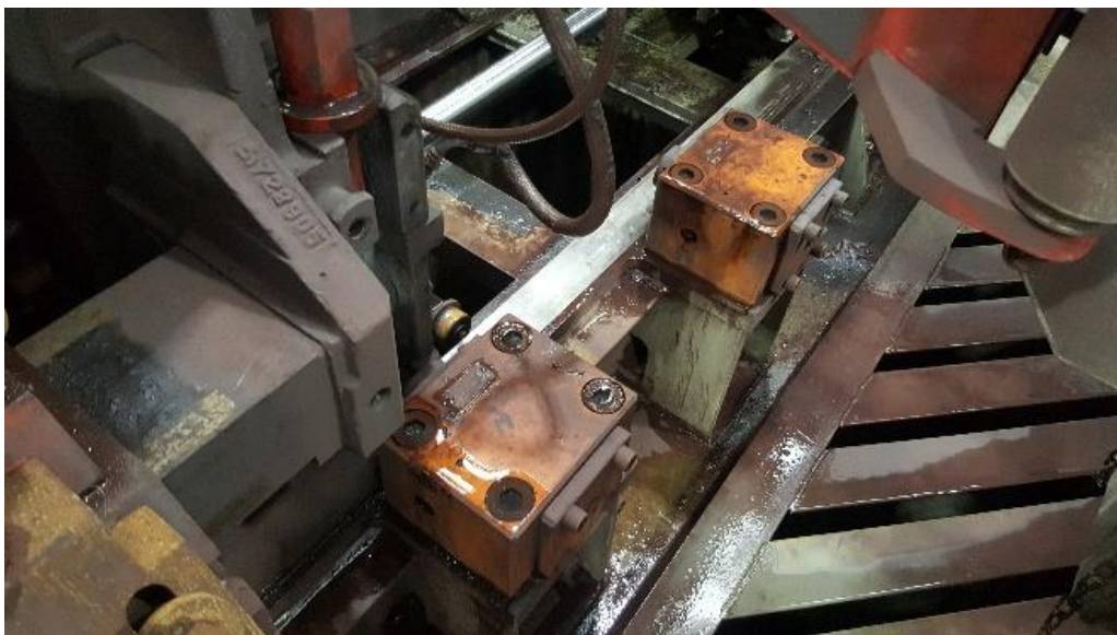
Slika 4.2 Dva stezna klina sa suprotne strane stana
