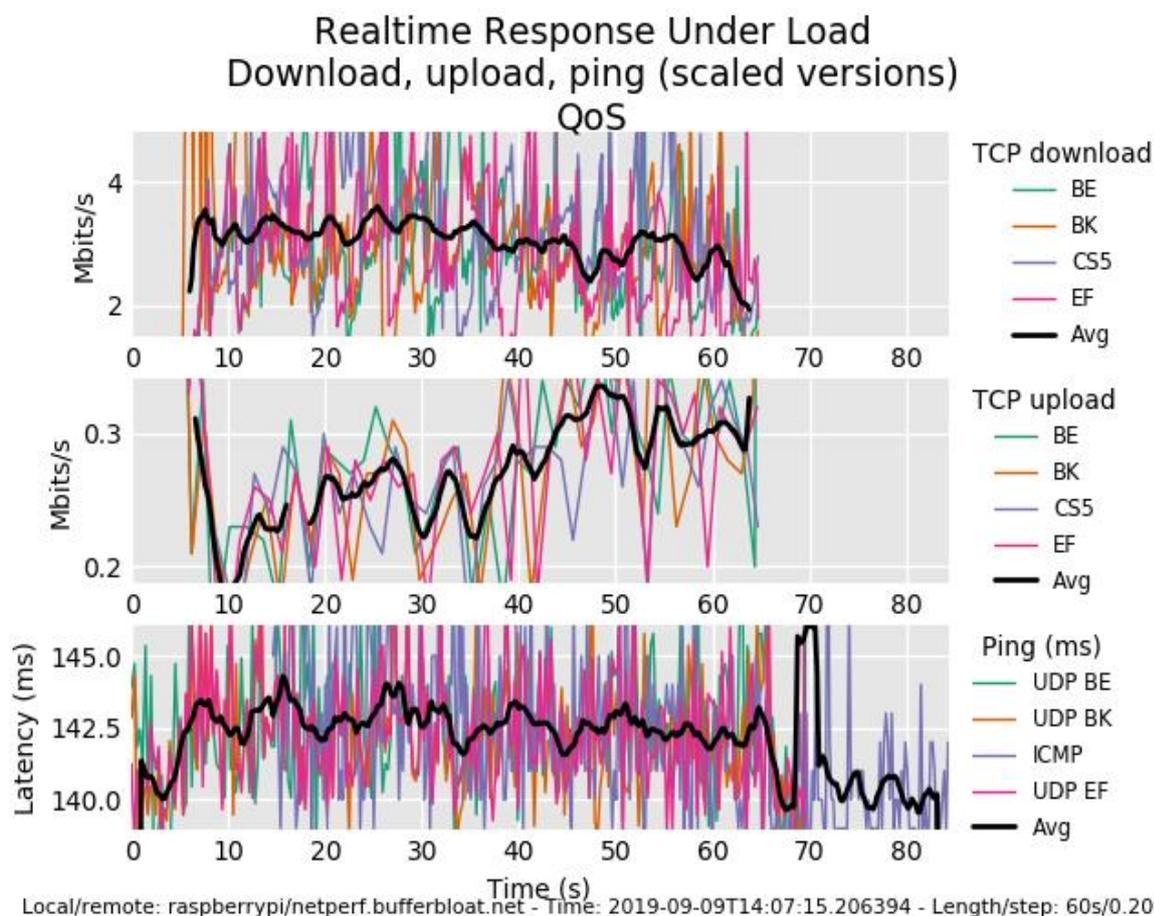
Slika 5.3. Odziv u realnom vremenu pri mrežnom opterećenju - preuzimanje podataka u dolaznom i odlaznom smjeru, ping (skalirane vrijednosti) - *QoS*
