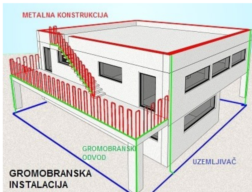
Slika 4.1. Prikaz gromobranskog sustava[10]
