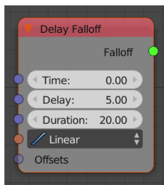
Slika 3.27. Delay Falloff čvor i predefinirane interpolacije
