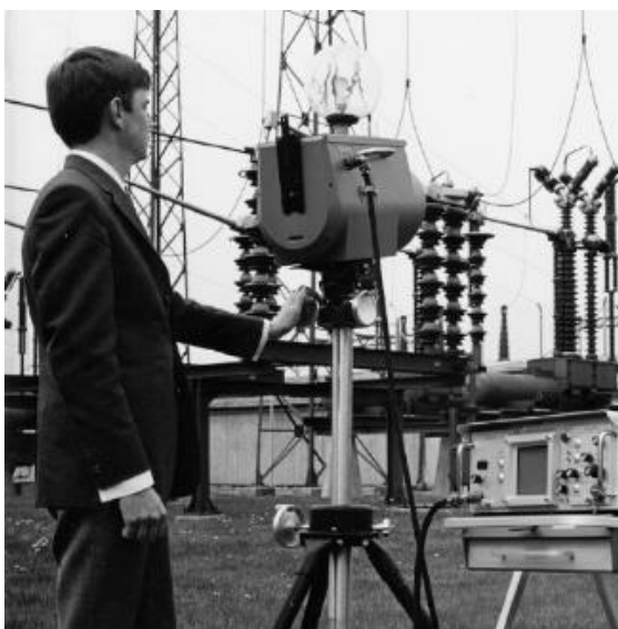
SI.2.2. Provedba termografske analize iz 1969. godine [3]
