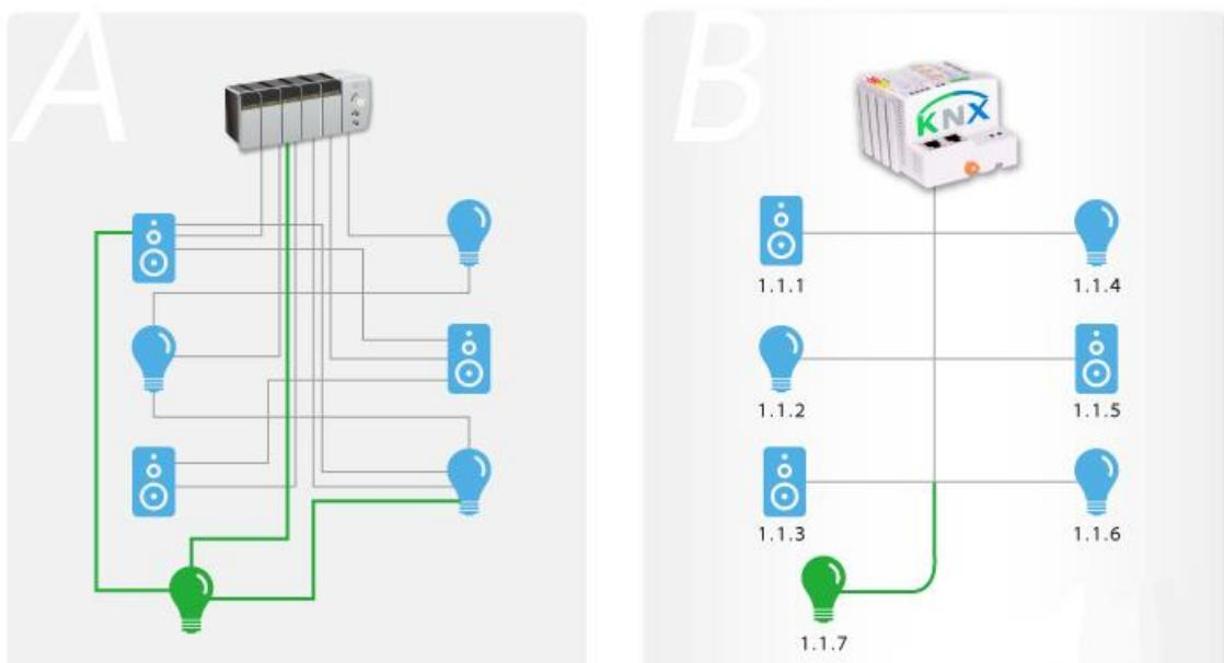
Slika 3.1. Usporedba klasičnih (lijevo) i pametnih (desno) instalacija [4]
