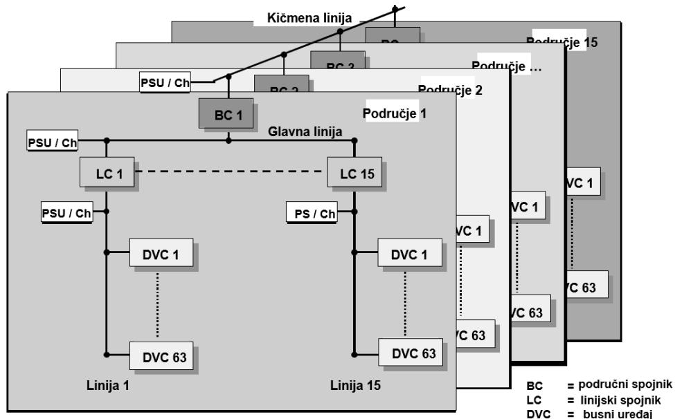
Slika 3.6. Više spojenih područja KNX instalacije [3]
