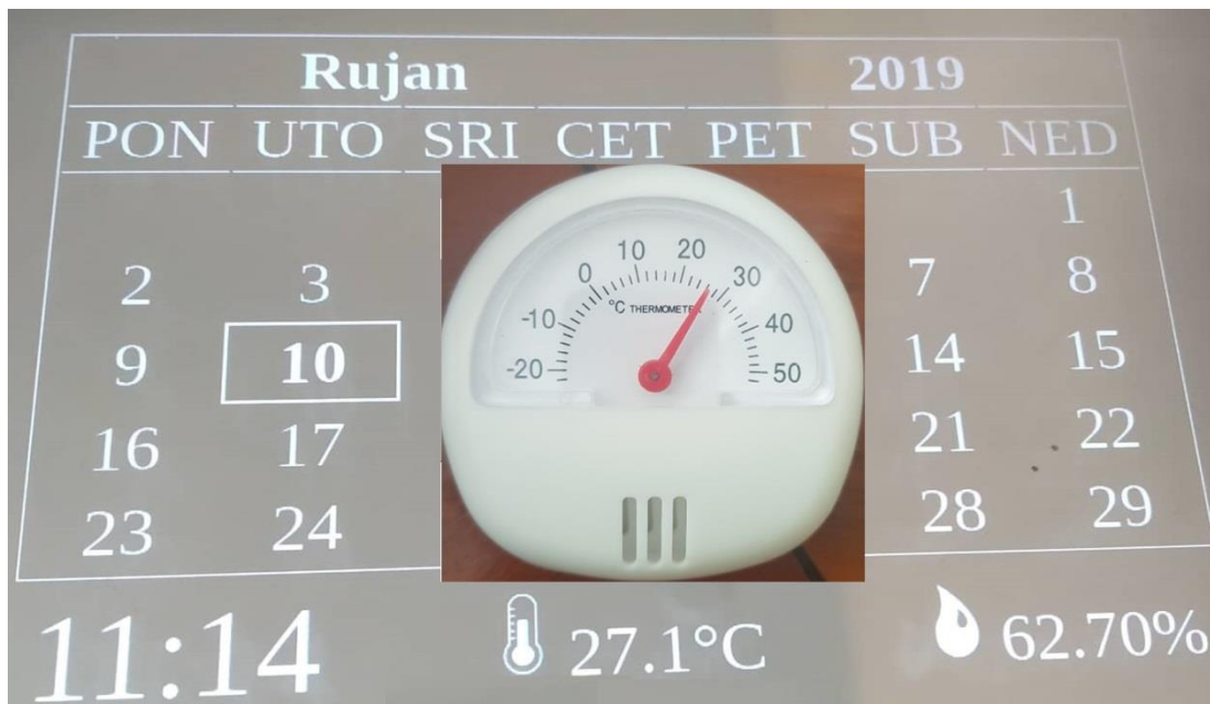
Slika 4.2. Testiranje preciznosti mjerenja temperature zraka.
