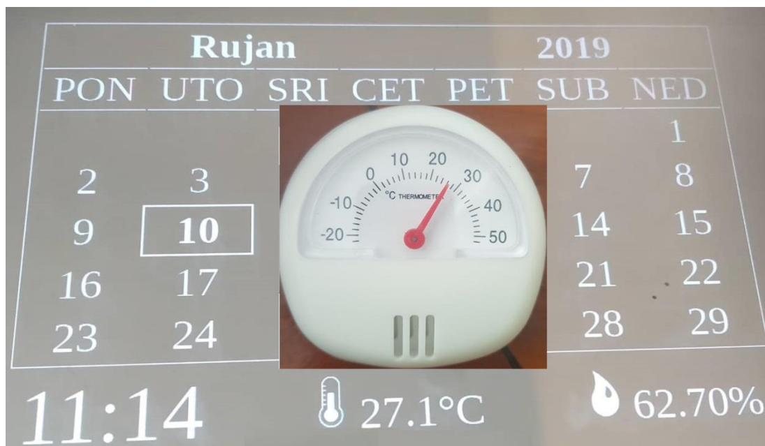
Slika 4.2. Testiranje preciznosti mjerenja temperature zraka.
