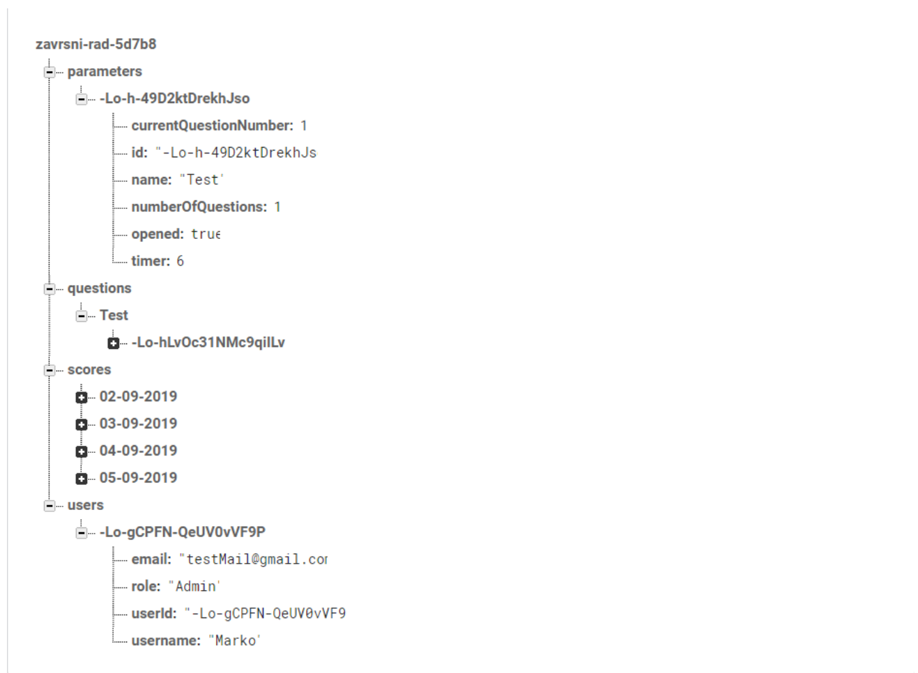
Slika 6.2. Prikaz strukture baze podataka Firebase
