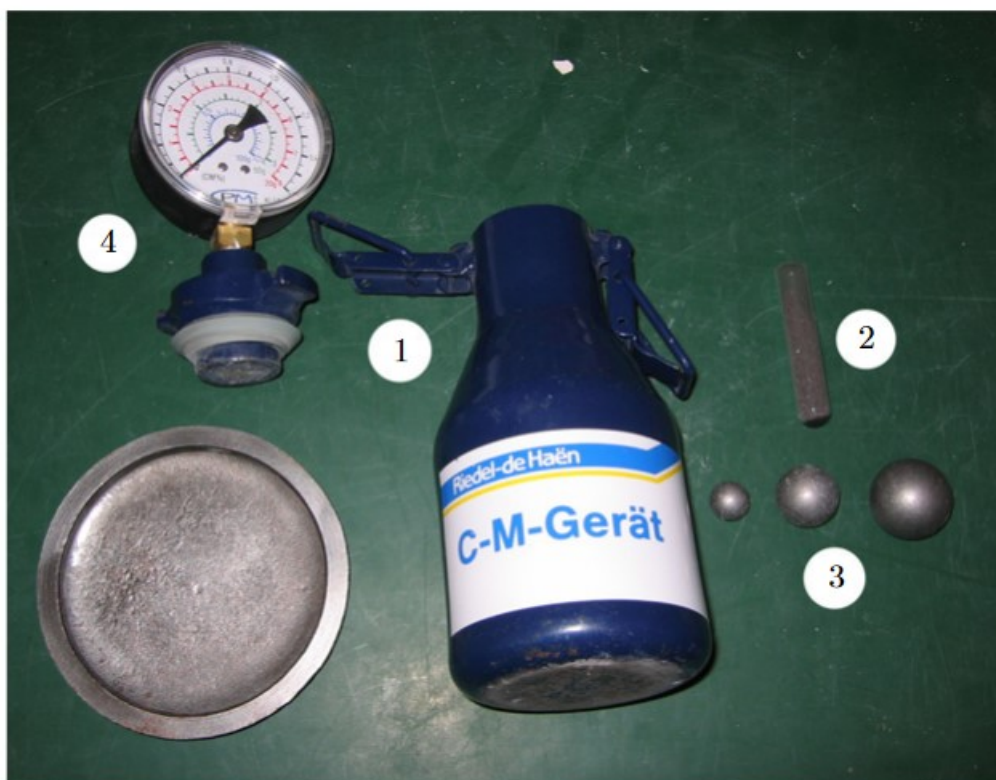
Slika 4.3. Oprema za mjerenje vlege metodom s kalcijevim karbidom: 1-posuda s plinom pod tlakom, 2-ampula kalcijevog karbida, 3-čelične kuglice, 4-mjerач. [3]
