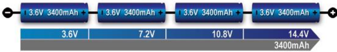
Slika 2.7. Serijski spoj četiri baterijske ćelije [19]
