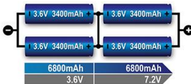
Slika 2.9. Serijsko-paralelni spoj četiri baterijske ćelije [19]
