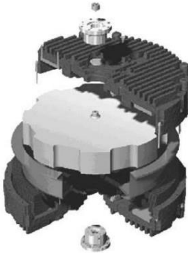
Slika 5.8. Zamašnjak za pohranu energije [1, str.69]
