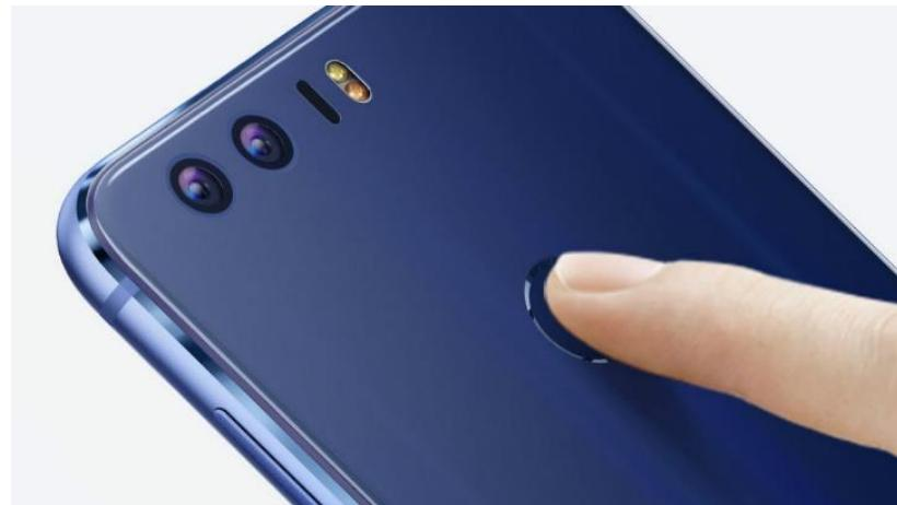
Sl. 2.2. Skener otiska prsta na mobilnom uređaju [7]
