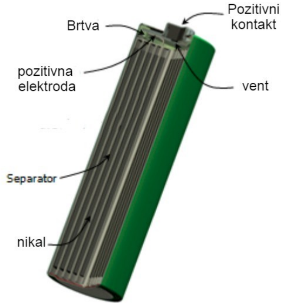
Slika 2.10 Dijelovi baterije ( https://www.semanticscholar.org )
