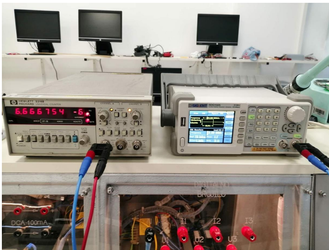
Slika 6.2. Digitalno brojilo Hewlett Packard 5316B i funkcijski generator koji su korišteni prilikom mjerenja
