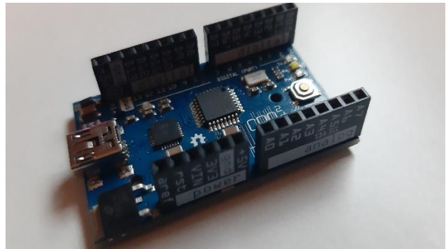
Slika 20 Croduino Basic 2 pločica
