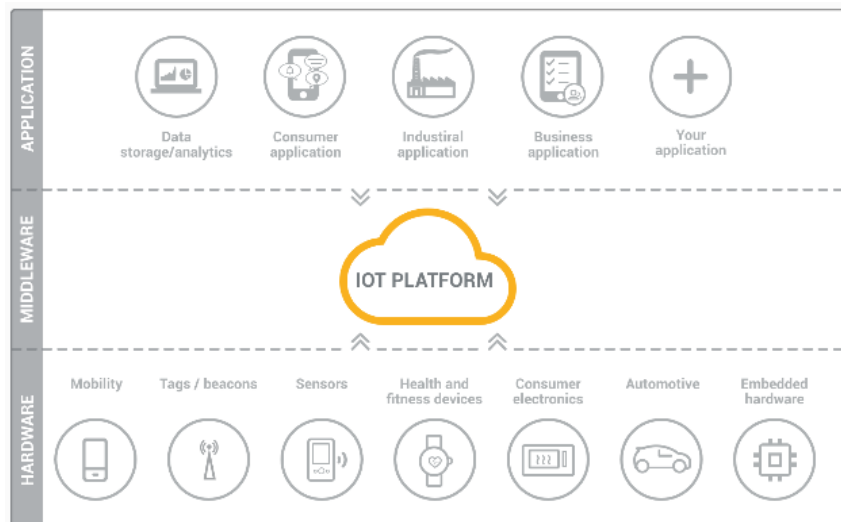
Slika 2.5: IoT platforma u ulozi srednjeg sloja [4]
