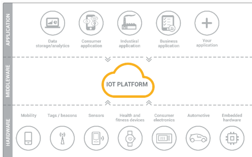
Slika 2.5: IoT platforma u ulozi srednjeg sloja [4]
