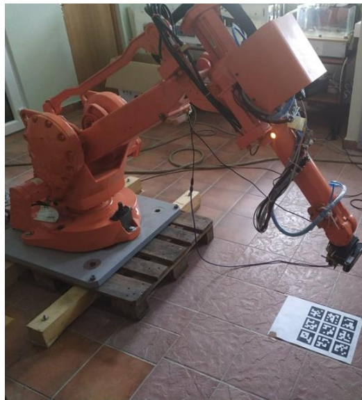
Slika 3.30 Jedan od položaja u postupku kalibracije
