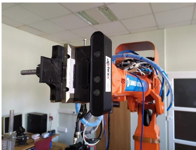
Slika 4.1 Robotski manipulator s postavljenom kamerom
