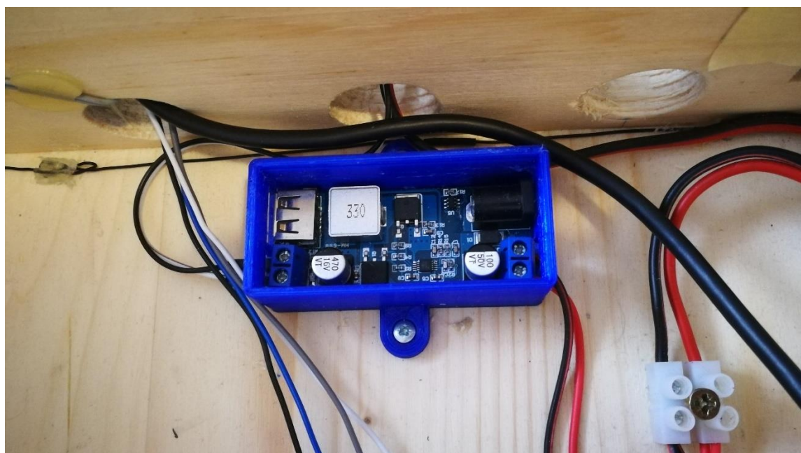
Sl.5.5. Pretvornik napona
