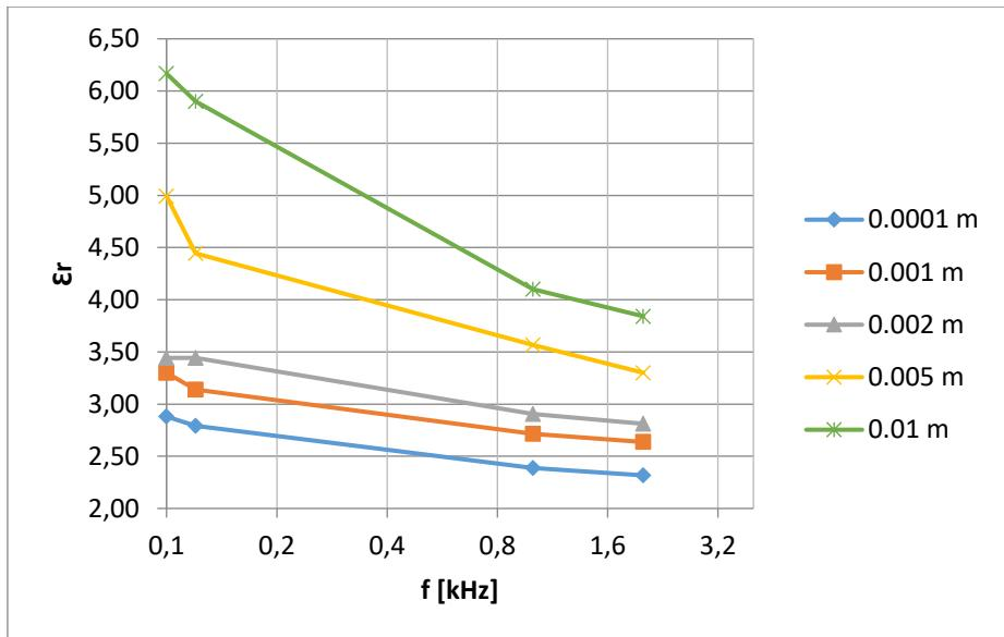
Slika 39. Relativna dielektrična konstanta  $\epsilon_r$  pločastog kondenzatora sa papirom kao dielektrik izmjerena GW Instek LCR-816 uređajem
