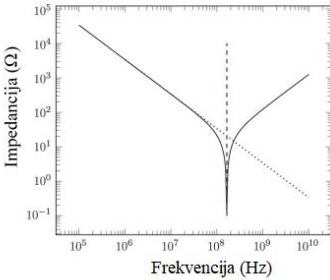
Slika 14. Ovisnost impedancije o frekvenciji realnog kondenzatora [23]
