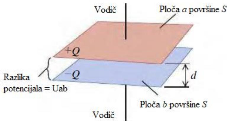
Slika 12. Pločasti kondenzator [12]
