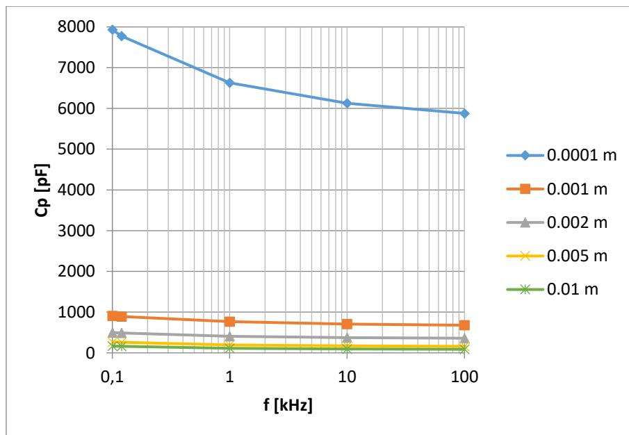
Slika 26. Paralelni kapacitet  $C_P$  pločastog kondenzatora sa papirom kao dielektrik izmjerjen UT612 uređajem
