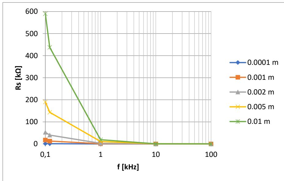
Slika 40. Serijski otpor  $R_s$  pločastog kondenzatora sa termoplastičnom folijom kao dielektrik izmjerjen UT612 uređajem
