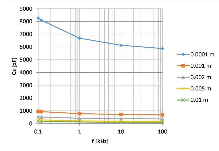
Slika 24. Serijski kapacitet  $C_s$  pločastog kondenzatora sa papirom kao dielektrik izmjereni UT612 uređajem
