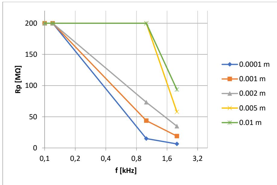
Slika 43. Paralelni otpor  $R_P$  pločastog kondenzatora sa termoplastičnom folijom kao dielektrik izmjerjen GW Instek LCR-816 uređajem
