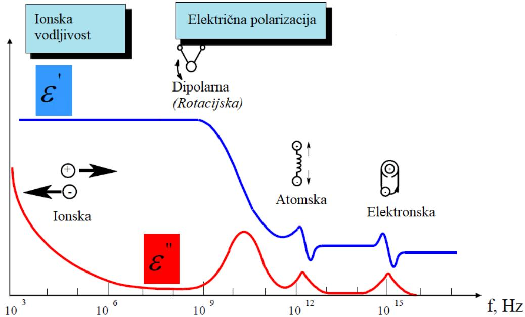
Slika 2. Vrste polarizacija ovisne o frekvenciji [7]
