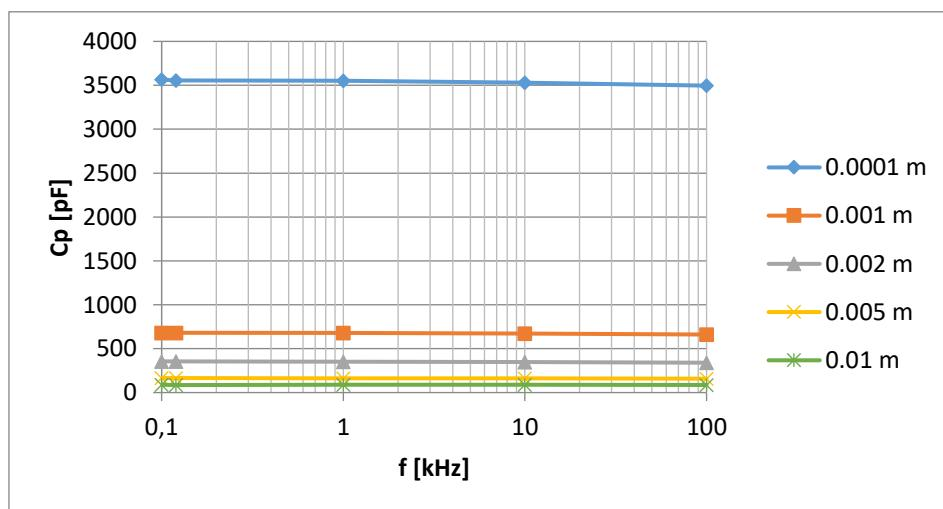
Slika 46. Paralelni kapacitet  $C_p$  pločastog kondenzatora sa termoplastičnom folijom kao dielektrik izmjereni UT612 uređajem
