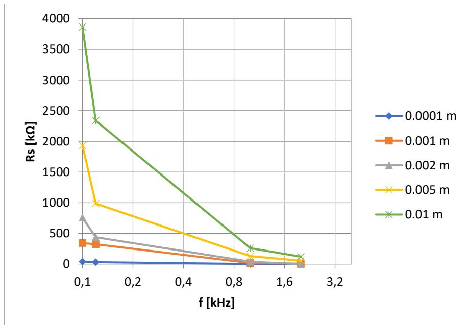
Slika 21. Serijski otpor  $R_s$  pločastog kondenzatora sa papirom kao dielektrik izmjerен GW Instek LCR-816 uređajem
