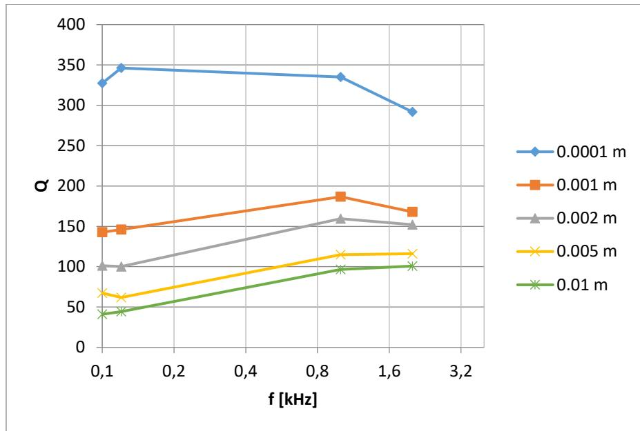
Slika 55. Faktor dobrote  $Q$  pločastog kondenzatora sa termoplastičnom folijom kao dielektrik izmjerен GW Instek LCR-816 uređajem
