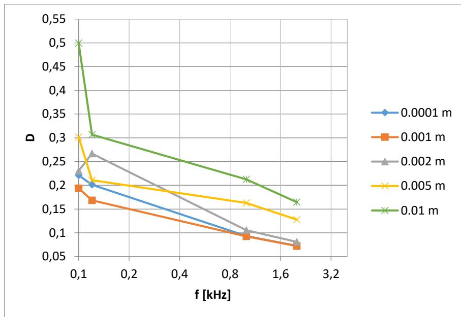
Slika 33. Faktor disipacije  $D$  pločastog kondenzatora sa papirom kao dielektrik izmjerен GW Instek LCR-816 uređajem
