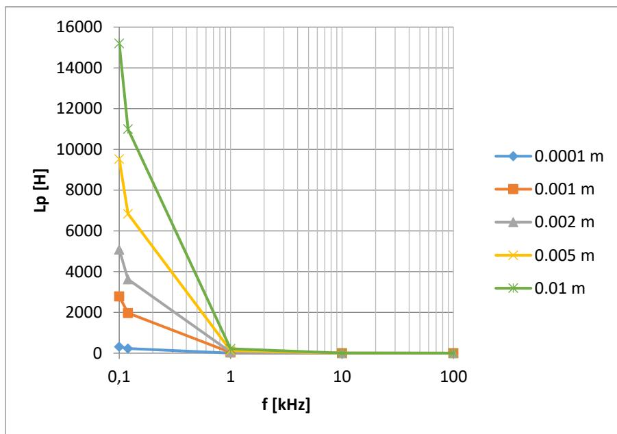
Slika 30. Paralelni induktivitet  $L_P$  pločastog kondenzatora sa papirom kao dielektrik izmjerjen UT612 uređajem
