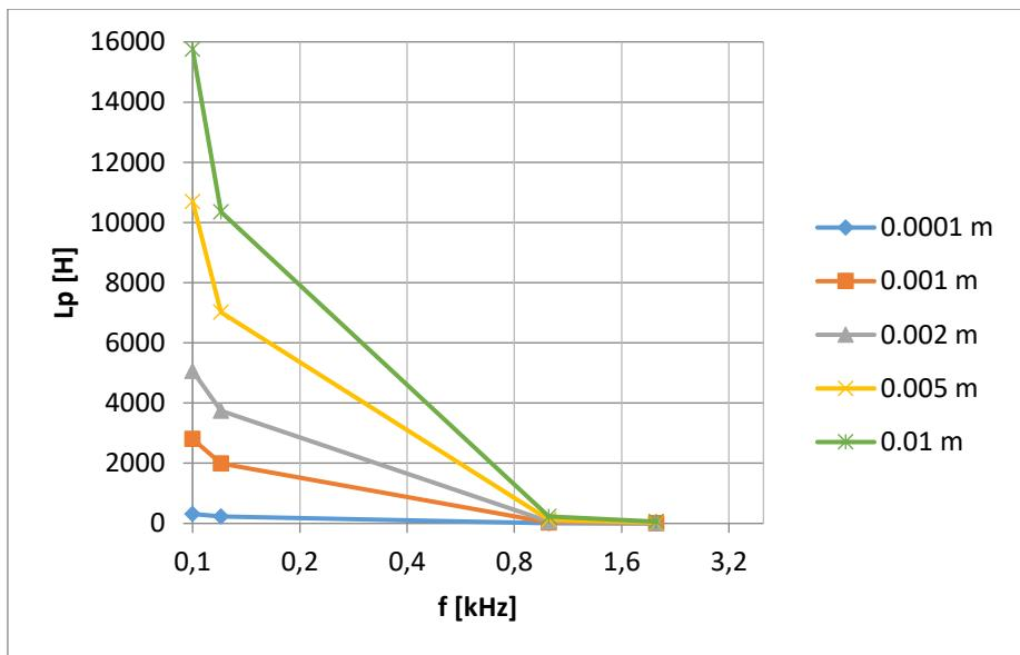
Slika 31. Paralelni induktivitet  $L_P$  pločastog kondenzatora sa papirom kao dielektrik izmjerjen GW Instek LCR-816 uređajem
