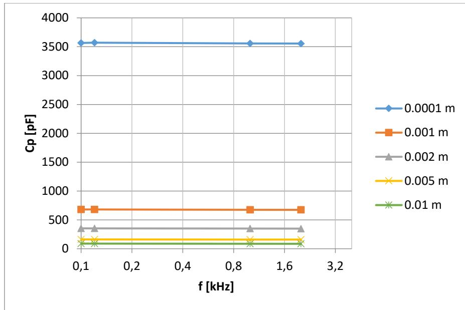
Slika 47. Paralelni kapacitet  $C_P$  pločastog kondenzatora sa termoplastičnom folijom kao dielektrik izmjerjen GW Instek LCR-816 uređajem
