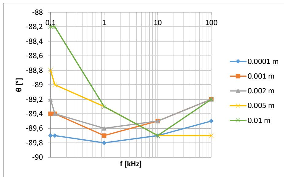
Slika 56. Kut faznog pomaka  $\theta$  pločastog kondenzatora sa termoplastičnom folijom kao dielektrik izmjerjen UT612 uređajem
