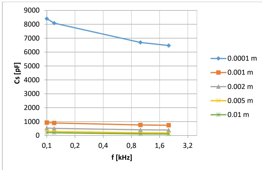
Slika 25. Serijski kapacitet  $C_s$  pločastog kondenzatora sa papirom kao dielektrik izmjerjen GW Instek LCR-816 uređajem
