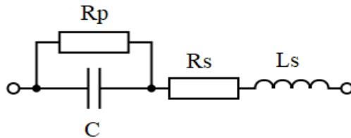
Slika 13. Nadomjesna shema realnog kondenzatora [14]
