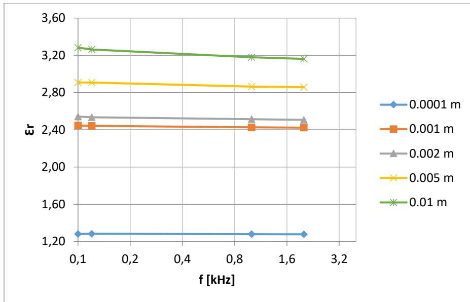
Slika 59. Relativna dielektrična konstanta  $\epsilon_r$  pločastog kondenzatora sa termoplastičnom folijom kao dielektrik izmjerena GW Instek LCR-816 uređajem
