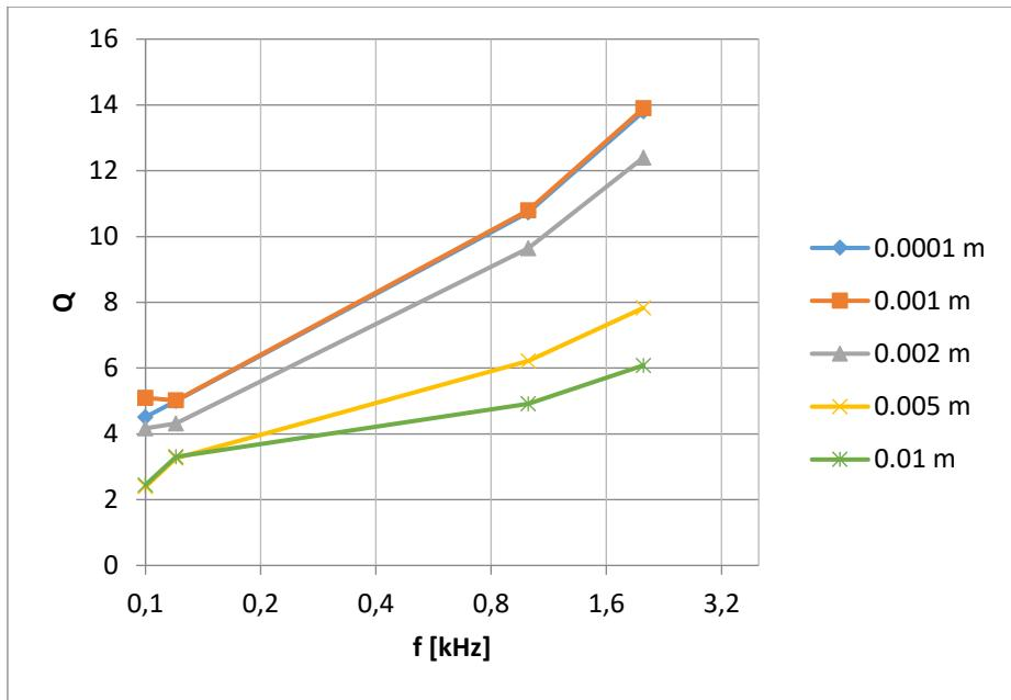
Slika 35. Faktor dobrote  $Q$  pločastog kondenzatora sa papirom kao dielektrik izmjerен GW Instek LCR-816 uređajem
