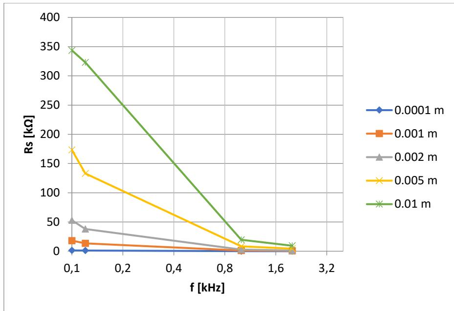
Slika 41. Serijski otpor  $R_s$  pločastog kondenzatora sa termoplastičnom folijom kao dielektrik izmjerен GW Instek LCR-816 uređajem
