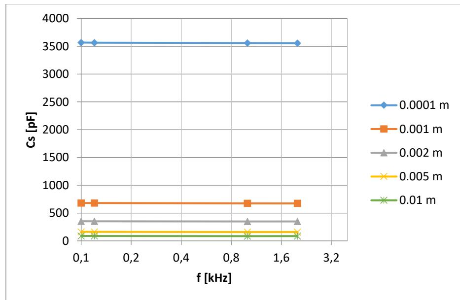
Slika 45. Serijski kapacitet  $C_s$  pločastog kondenzatora sa termoplastičnom folijom kao dielektrik izmjerjen GW Instek LCR-816 uređajem
