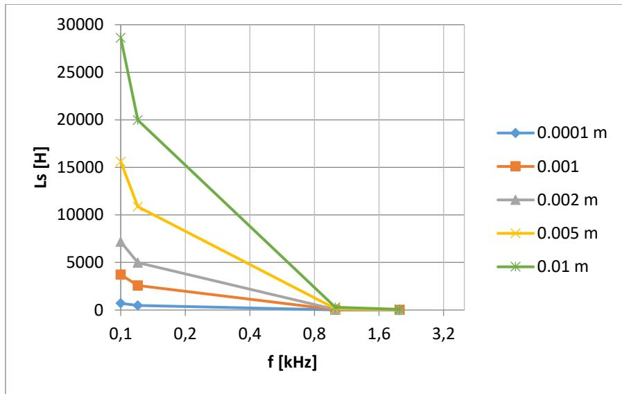
Slika 49. Serijski induktivitet  $L_S$  pločastog kondenzatora sa termoplastičnom folijom kao dielektrik izmjerен GW Instek LCR-816 uređajem
