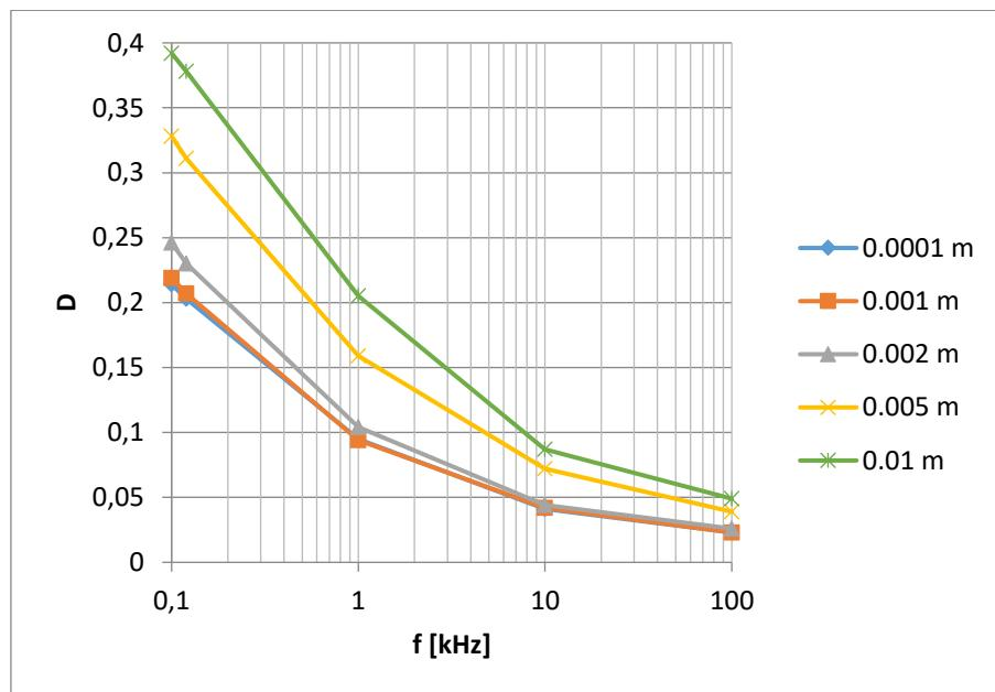
Slika 32. Faktor disipacije  $D$  pločastog kondenzatora sa papirom kao dielektrik izmjerjen UT612 uređajem
