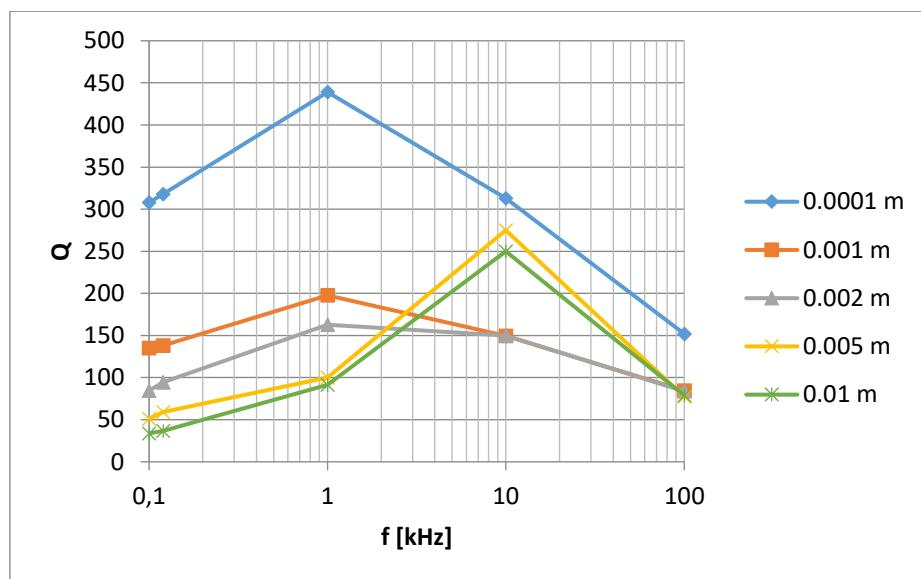
Slika 54. Faktor dobrote  $Q$  pločastog kondenzatora sa termoplastičnom folijom kao dielektrik izmjerjen UT612 uređajem
