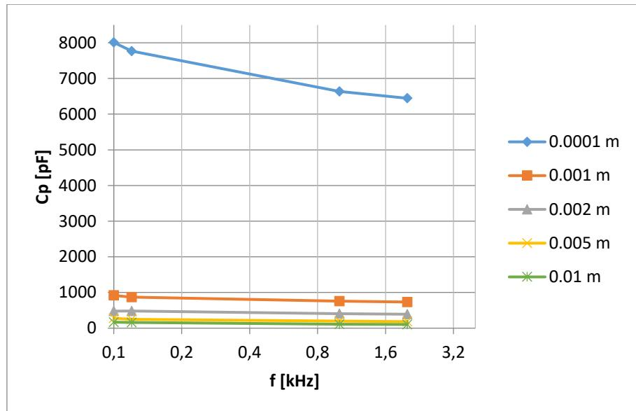
Slika 27. Paralelni kapacitet  $C_P$  pločastog kondenzatora sa papirom kao dielektrik izmjerен GW Instek LCR-816 uređajem
