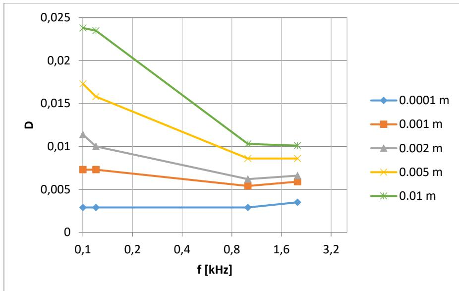
Slika 53. Faktor disipacije  $D$  pločastog kondenzatora sa termoplastičnom folijom kao dielektrik izmjerjen GW Instek LCR-816 uređajem
