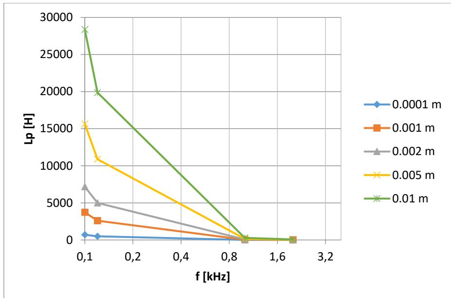
Slika 51. Paralelni induktivitet  $L_P$  pločastog kondenzatora sa termoplastičnom folijom kao dielektrik izmjerena GW Instek LCR-816 uređajem
