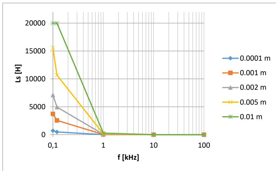
Slika 48. Serijski induktivitet  $L_s$  pločastog kondenzatora sa termoplastičnom folijom kao dielektrik izmjerен UT612 uređajem
