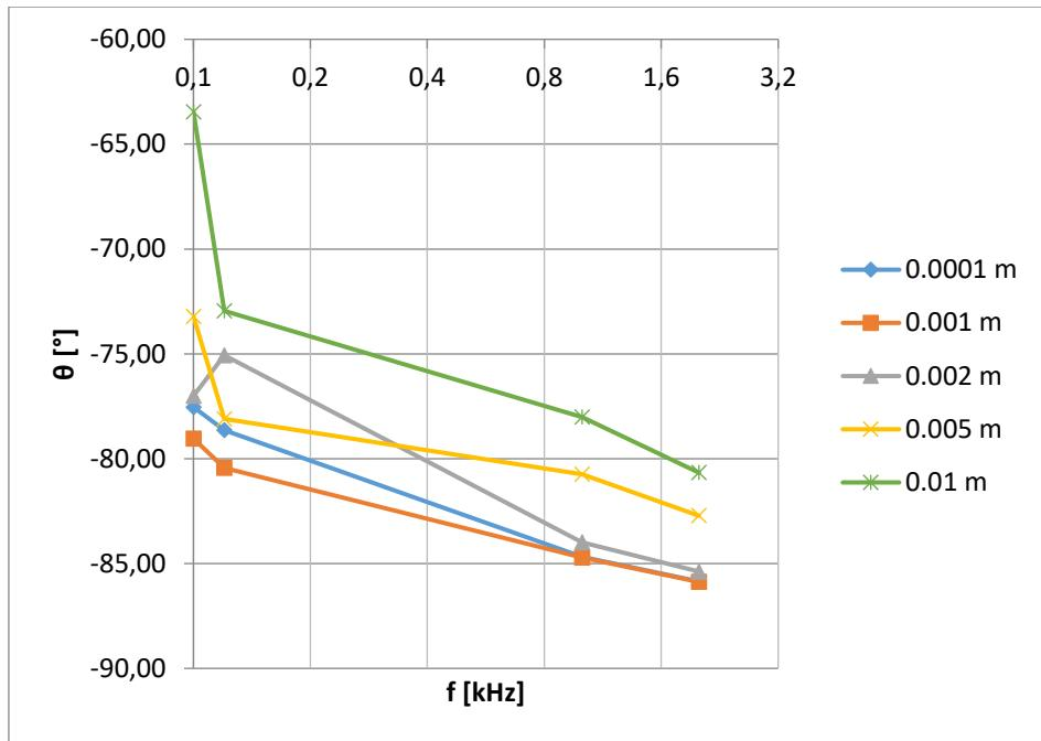
Slika 37. Kut faznog pomaka  $\theta$  pločastog kondenzatora sa papirom kao dielektrik izmjerjen GW
