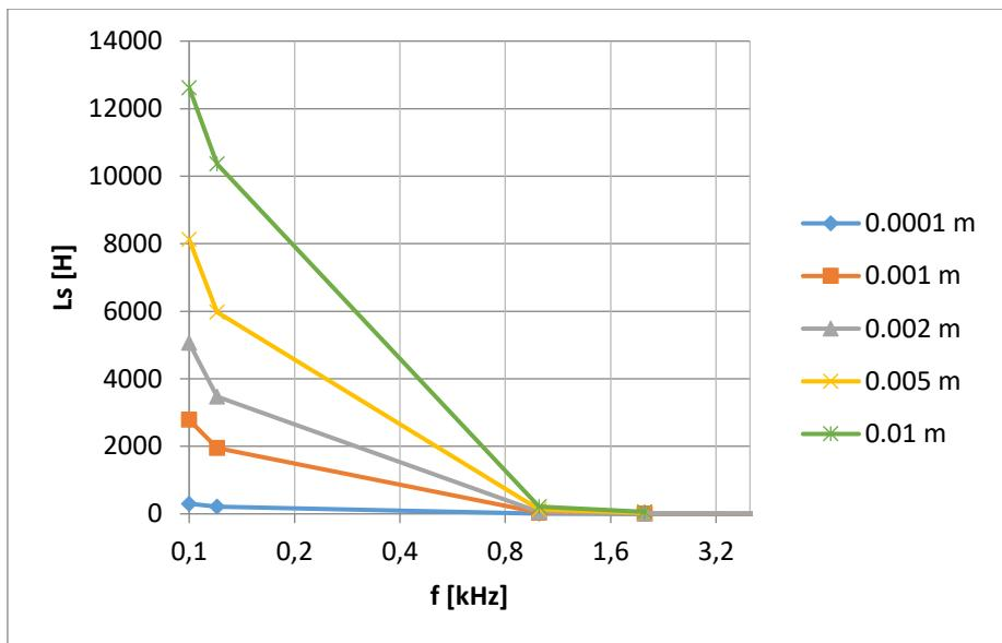
Slika 29. Serijski induktivitet  $L_s$  pločastog kondenzatora sa papirom kao dielektrik izmjerjen GW
