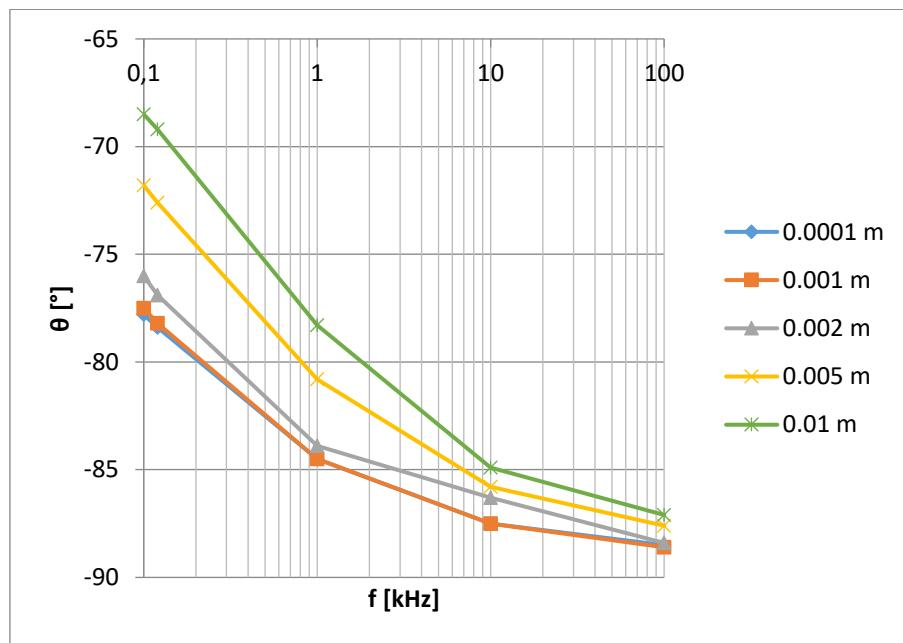
Slika 36. Kut faznog pomaka  $\theta$  pločastog kondenzatora sa papirom kao dielektrik izmjerен UT612 uređajem
