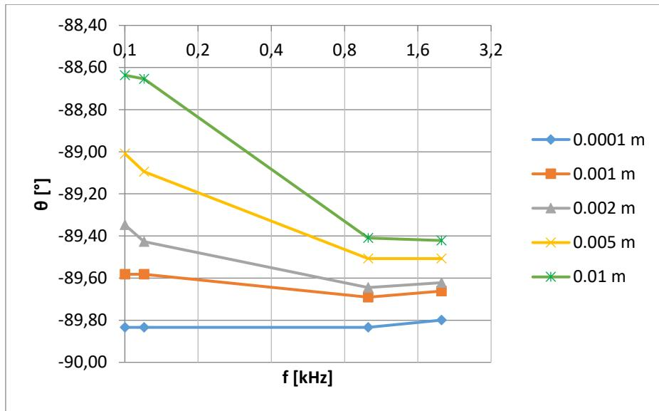
Slika 57. Kut faznog pomaka  $\theta$  pločastog kondenzatora sa termoplastičnom folijom kao dielektrik izmjerен GW Instek LCR-816 uređajem
