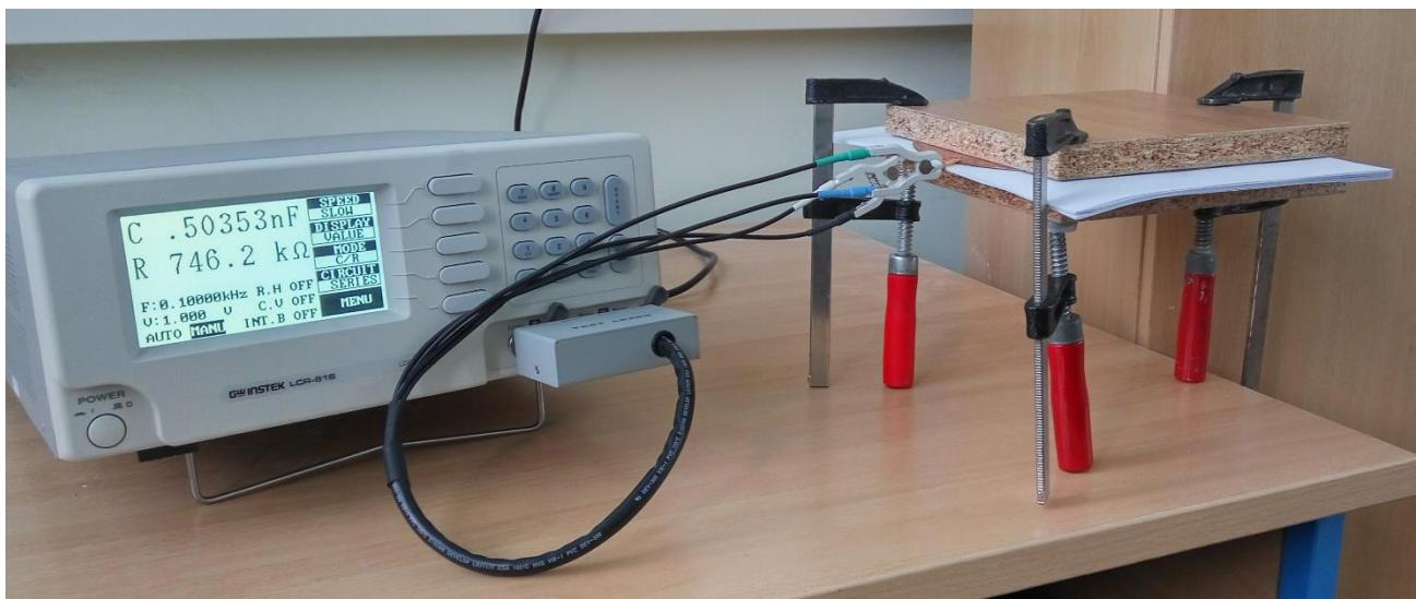
Slika 19. Prikaz mjerena kapaciteta pločastog kondenzatora u laboratoriju
