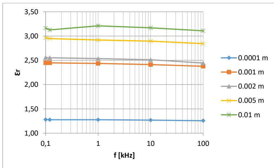
Slika 58. Relativna dielektrična konstanta  $\varepsilon_r$  pločastog kondenzatora sa termoplastičnom folijom kao dielektrik izmjeren UT612 uređajem
