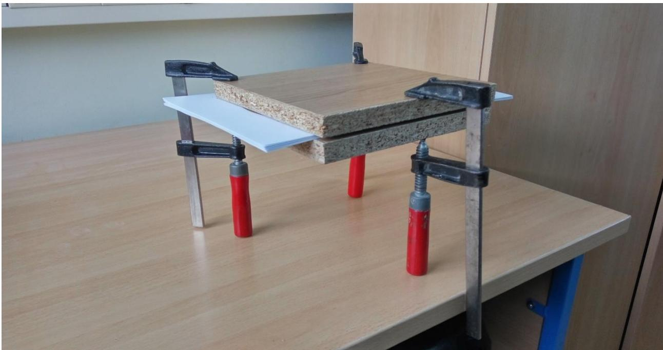
Slika 17. Stabilizacija pločastog kondenzatora drvenim oblogama i stegom
