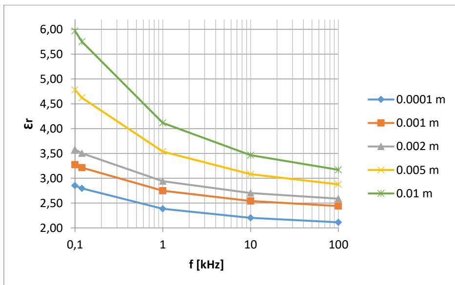
Slika 38. Relativna dielektrična konstanta  $\varepsilon_r$  pločastog kondenzatora sa papirom kao dielektrik izmjerena UT612 uređajem
