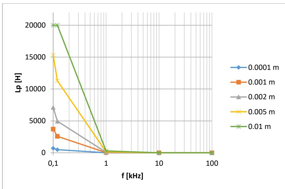
Slika 50. Paralelni induktivitet  $L_p$  pločastog kondenzatora sa termoplastičnom folijom kao dielektrik izmjerен UT612 uređajem
