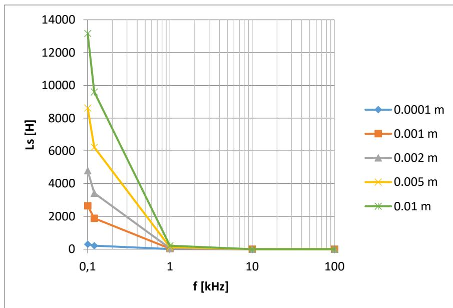
Slika 28. Serijski induktivitet  $L_s$  pločastog kondenzatora sa papirom kao dielektrik izmjerен UT612 uređajem
