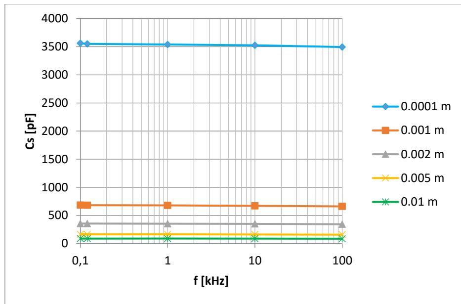
Slika 44. Serijski kapacitet  $C_s$  pločastog kondenzatora sa termoplastičnom folijom kao dielektrik izmjerен UT612 uređajem
