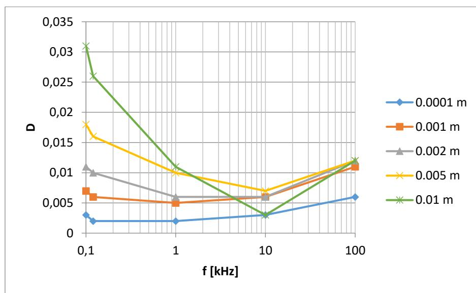
Slika 52. Faktor disipacije  $D$  pločastog kondenzatora sa termoplastičnom folijom kao dielektriku izmjerjen UT612 uređajem
