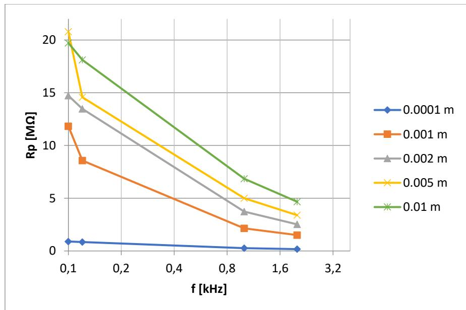
Slika 23. Paralelni otpor  $R_P$  pločastog kondenzatora sa papirom kao dielektrik izmjerен GW Instek LCR-816 uređajem
