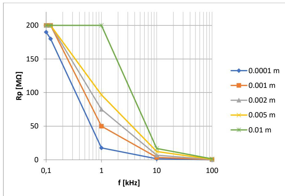
Slika 42. Paralelni otpor  $R_P$  pločastog kondenzatora sa termoplastičnom folijom kao dielektrik izmjerjen UT612 uređajem
