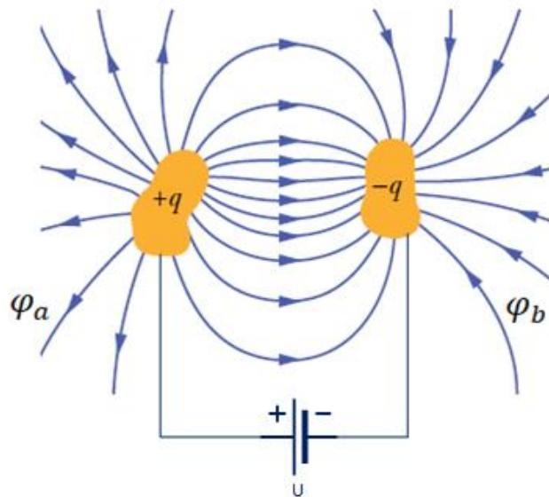
Slika 10. Naboji priključeni na izvor napajanja [10]
