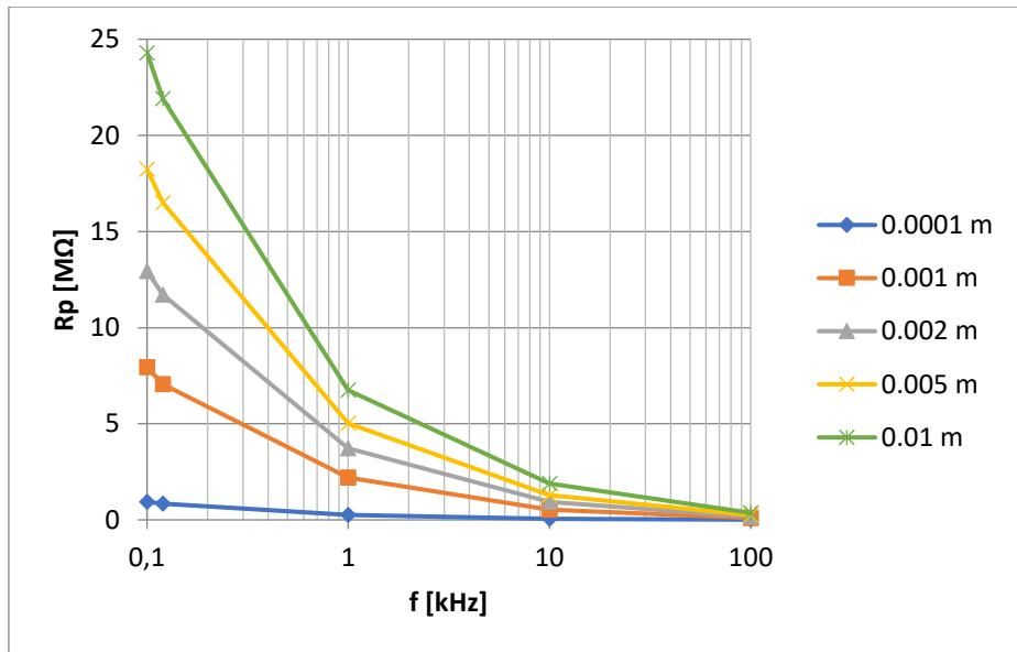
Slika 22. Paralelni otpor  $R_P$  pločastog kondenzatora sa papirom kao dielektrik izmjerен UT612 uređajem
