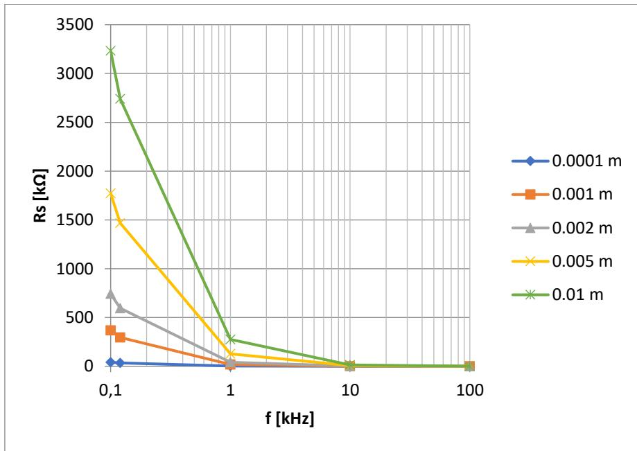
Slika 20. Serijski otpor  $R_s$  pločastog kondenzatora sa papirom kao dielektrik izmjerен UT612 uređajem
