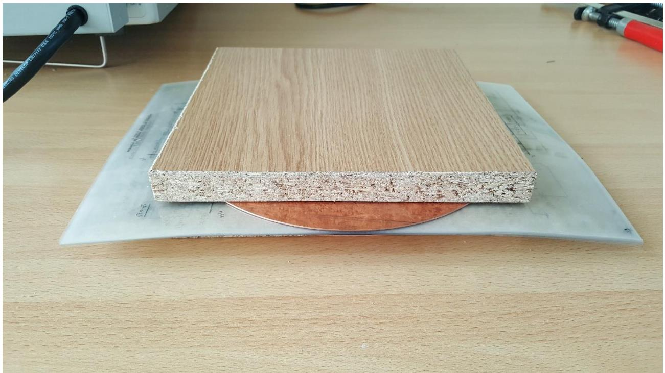
Slika 16. Prikaz pločastog kondenzatora sa folijom od termoplastičnog polimera
