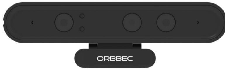
Slika 3.3. Orbbec Astra S RGB-D kamera
