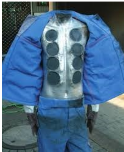
Slika 2.10. Raspored termopara na opremi RWEeurotest-a. [6]
