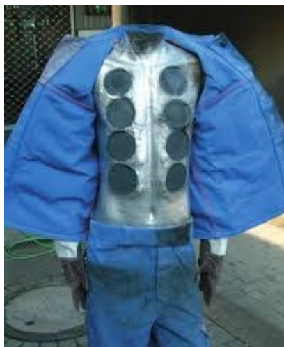
Slika 2.10. Raspored termopara na opremi RWEeurotest-a. [6]
