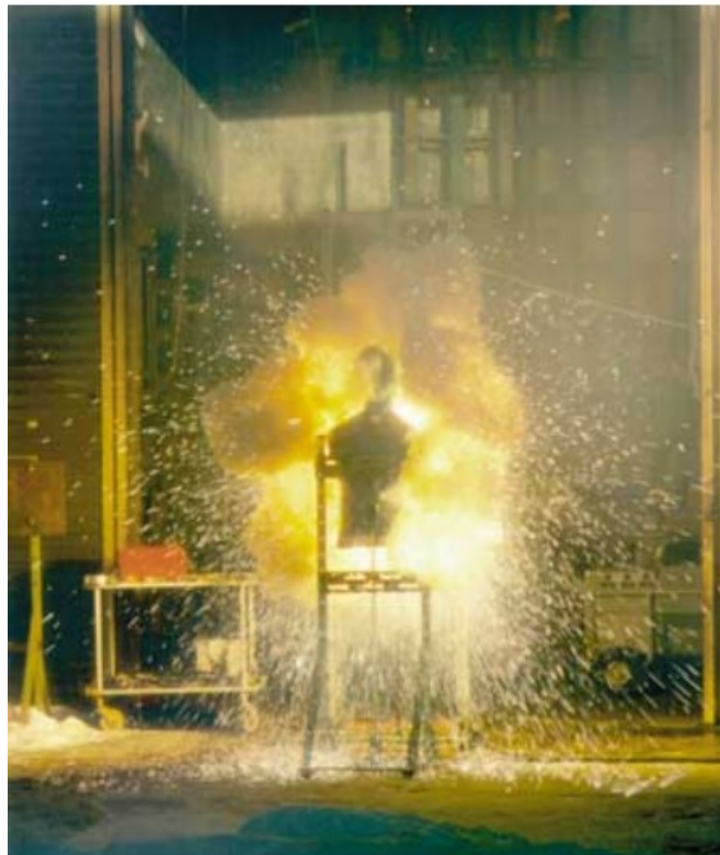
Slika 2.8. Test električnog luka prema CENELEC-ovom ispitnom postupku - ispitivanje radne jakne 2. klase. [3]
