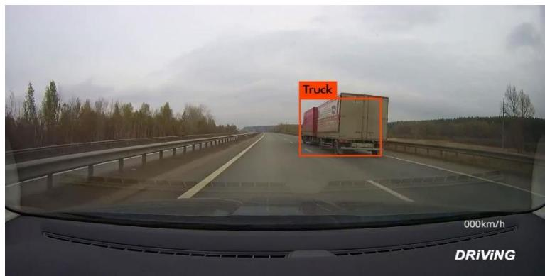
Slika 4.4. Detekcija objekata pomoću Yolo v2 algoritma po danu
