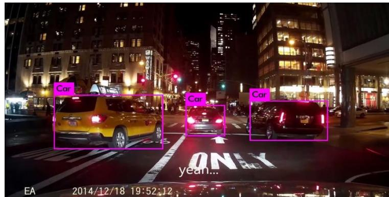
**Slika 4.1.** Detekcija objekata pomoću *Yolo v2* algoritma po noći
