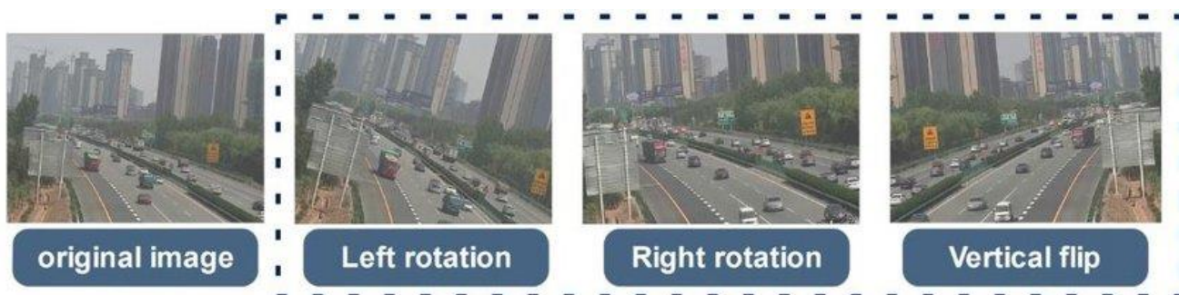
Slika 2.4. Primjer DA korištenjem lijeve rotacije, desne rotacije i okomitog zakretanja [7].
