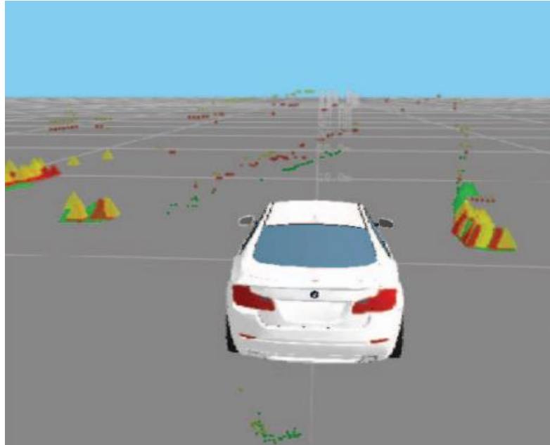
Slika 2.3. Scenarij s detektiranim kapljicama kiše [5].
