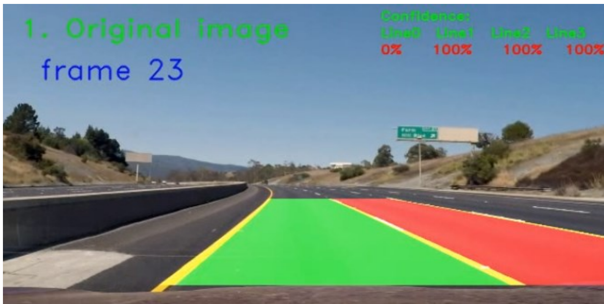
Slika. 3.14. Prikaz detektiranih linija i obojanih voznih traka na izvornoj slici.
