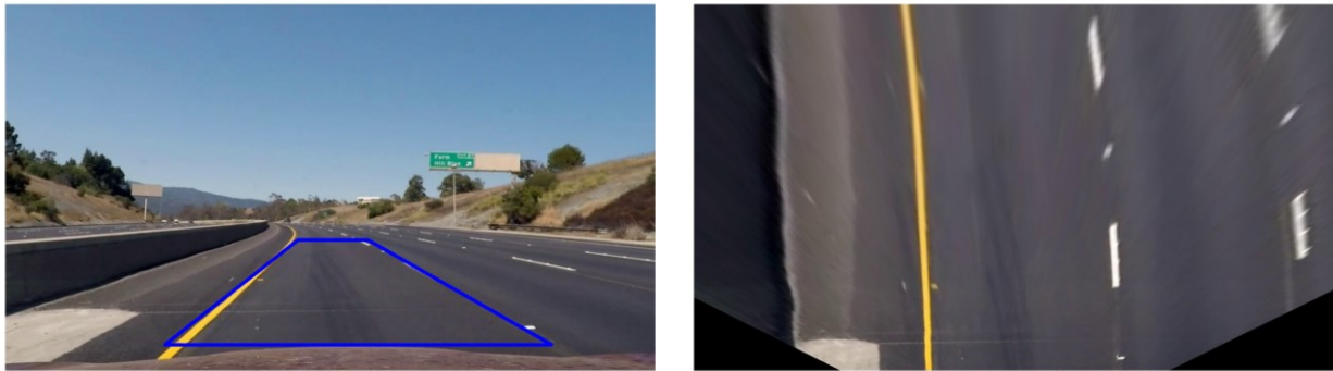
Slika. 3.6. Primjer transformacije perspektive slike: (a) ispravljena slika bez izobličenja kojeg unosi kamera, s označenim ROI-jem, (b) ROI sa slike (a) iz ptičje perspektive, nakon provedene transformacije perspektive
