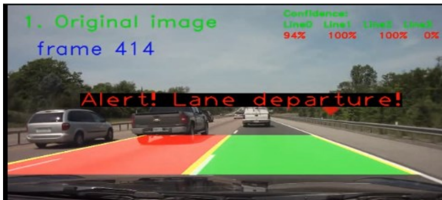
Slika. 3.16. Prikaz izgleda ispisa upozorenja o napuštanju vlastite vozne trake na izvornoj slici snimke.
