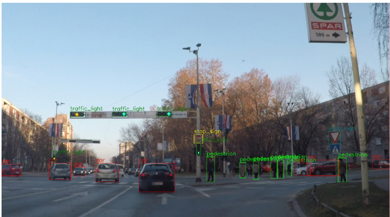
Sl. 2.1. Primjer idealne detekcije objekata u slici dobivenoj s prednje kamere u vozilu
