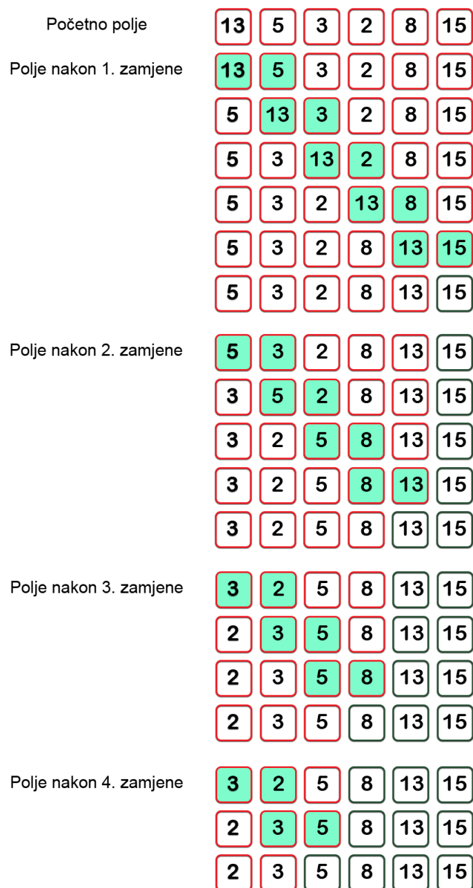
Slika 3.3. Postupak izvođenja Bubble sort algoritma zamjenom susjednih elemenata.
