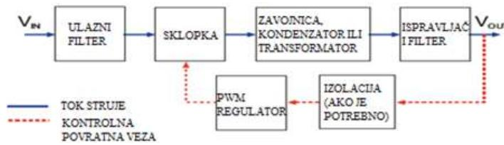
Slika 2.2. Blok dijagram sklopnog regulatora.
