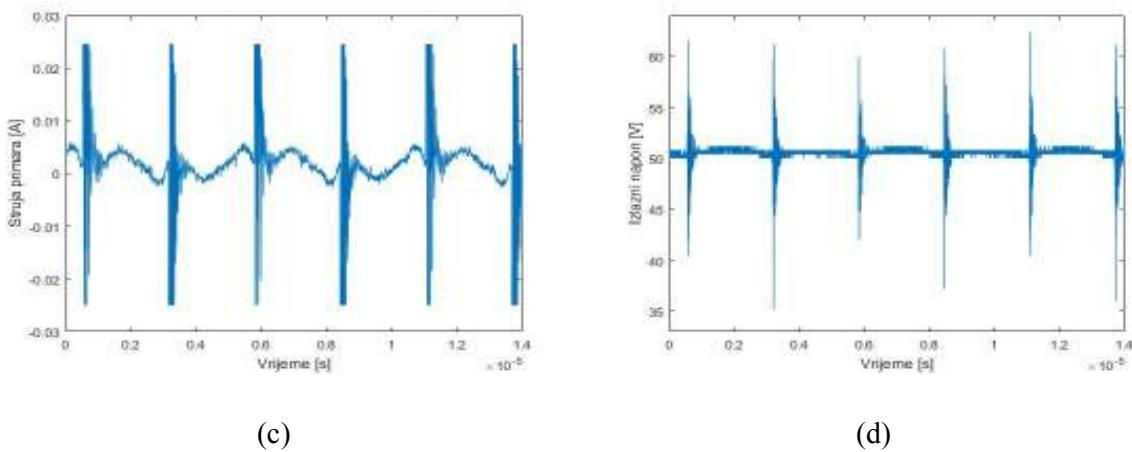
**Slika 4.9.** Valni oblici pri sklopnjoj frekvenciji od 200 kHz: a) napon primara, b) napon sekundara, c) struja primara, d) izlazni napon.
