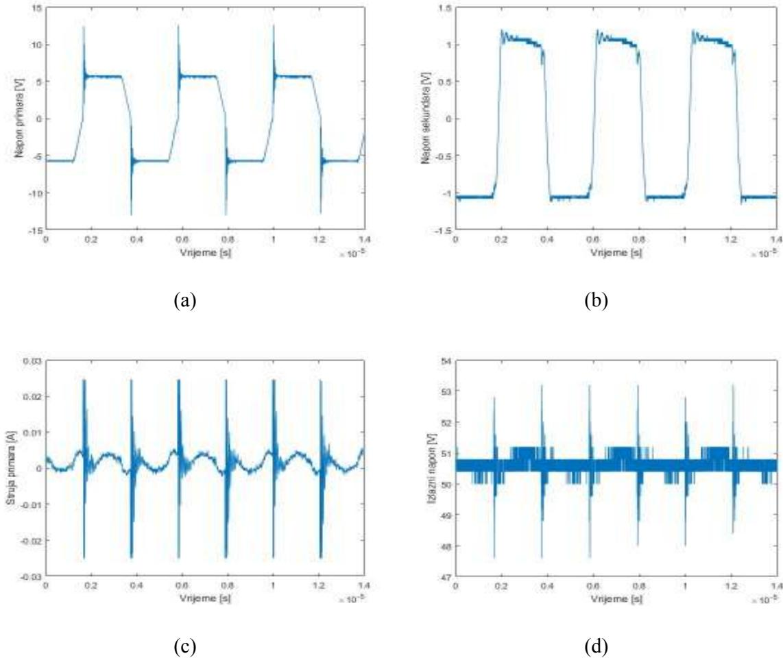
**Slika 4.13.** Valni oblici pri sklopnjoj frekvenciji od 240 kHz: a) napon primara, b) napon sekundara, c) struja primara, d) izlazni napon.
