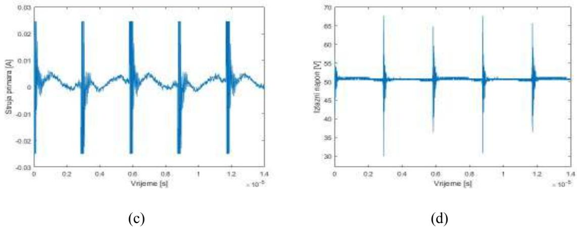
**Slika 4.6.** Valni oblici pri sklopnjoj frekvenciji od 170 kHz: a) napon primara, b) napon sekundara, c) struja primara, d) izlazni napon.
