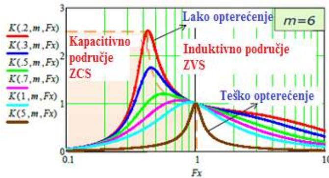
Slika 2.16. Prikaz područja kapacitivnog i induktivnog rada.
