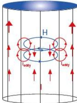
**Slika 3.4.** Raspodjela struje širom poprečnog presjeka vodiča.
