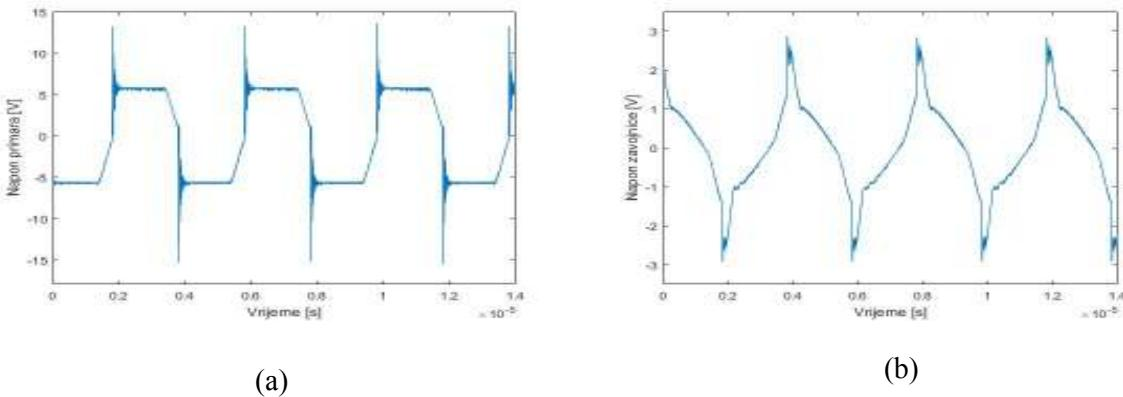
**Slika 4.17.** Napon primara a) i rezonantne zavojnice b) na sklopnjoj frekvenciji od 250 kHz s opterećenjem.
