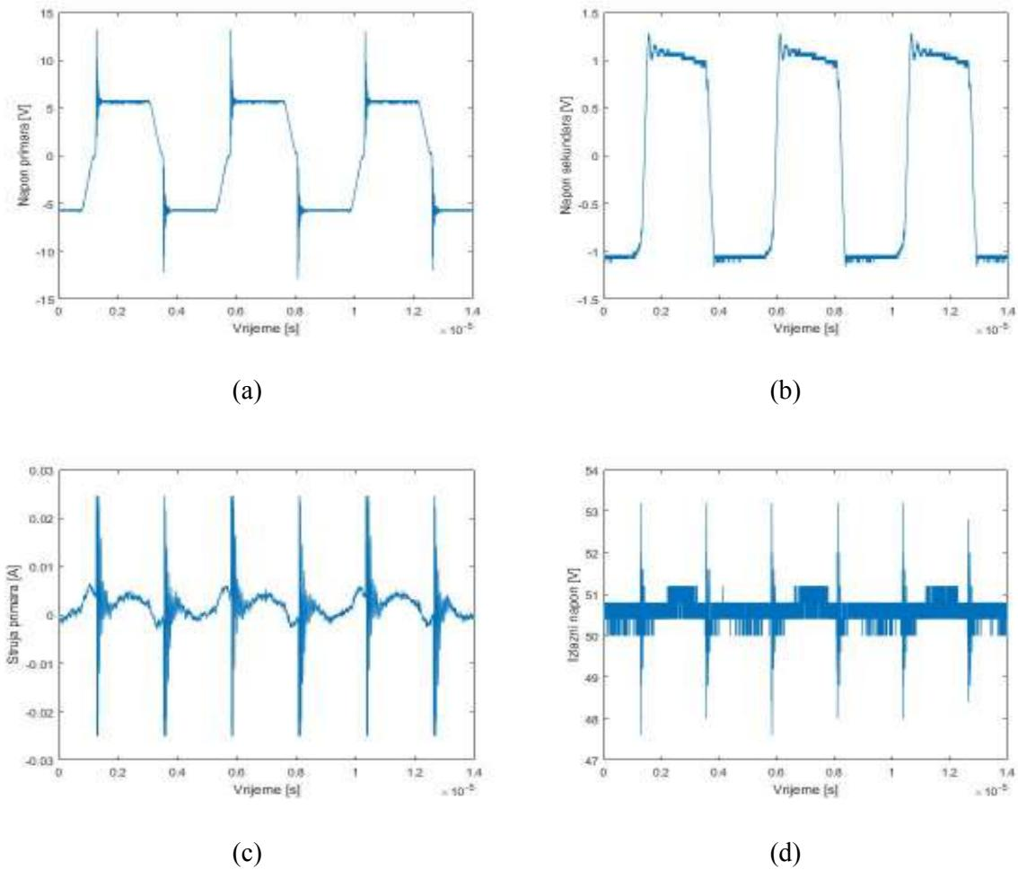
**Slika 4.11.** Valni oblici pri sklopnjoj frekvenciji od 220 kHz: a) napon primara, b) napon sekundara, c) struja primara, d) izlazni napon.
