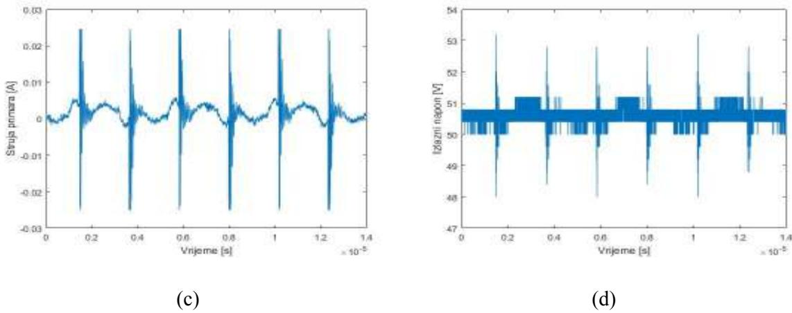
**Slika 4.12.** Valni oblici pri sklopnjoj frekvenciji od 230 kHz: a) napon primara, b) napon sekundara, c) struja primara, d) izlazni napon.
