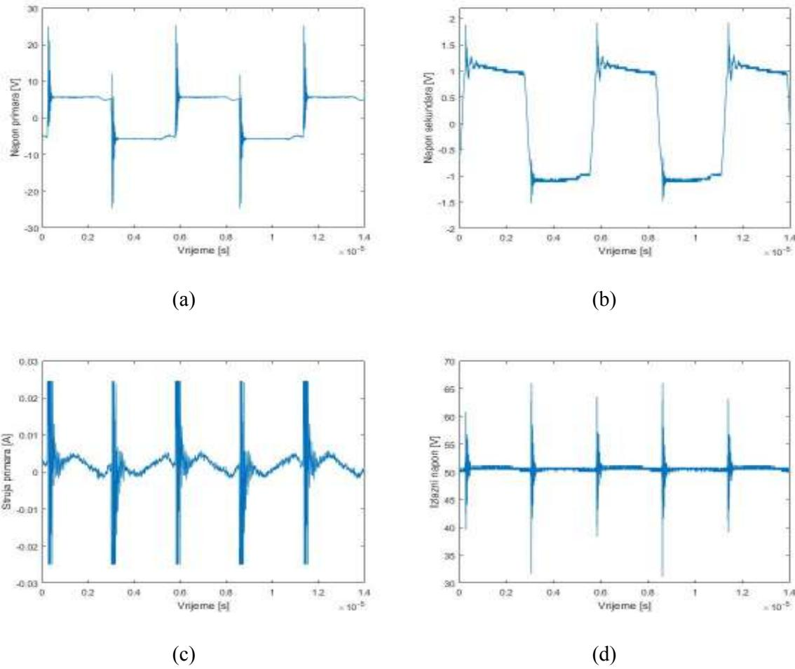
**Slika 4.7.** Valni oblici pri sklopnjoj frekvenciji od 180 kHz: a) napon primara, b) napon sekundara, c) struja primara, d) izlazni napon.
