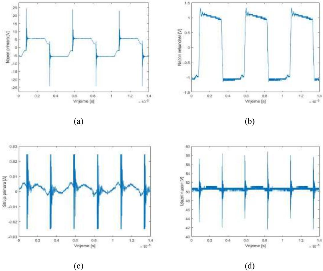
**Slika 4.10.** Valni oblici pri sklopnjoj frekvenciji od 210 kHz: a) napon primara, b) napon sekundara, c) struja primara, d) izlazni napon.
