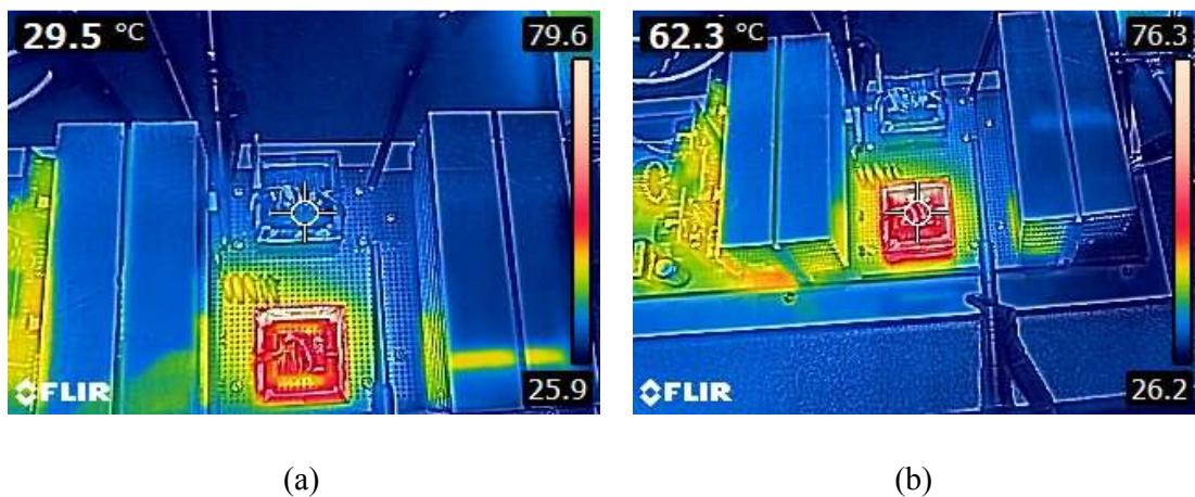
**Slika 4.19.** Prikaz zagrijavanja dijelova pretvarača: a) transformator, b) rezonantna zavojnica.
