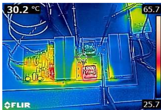
Slika 4.20. Prikaz zagrijavanja rezonantnog kondenzatora i svih ostalih dijelova.
