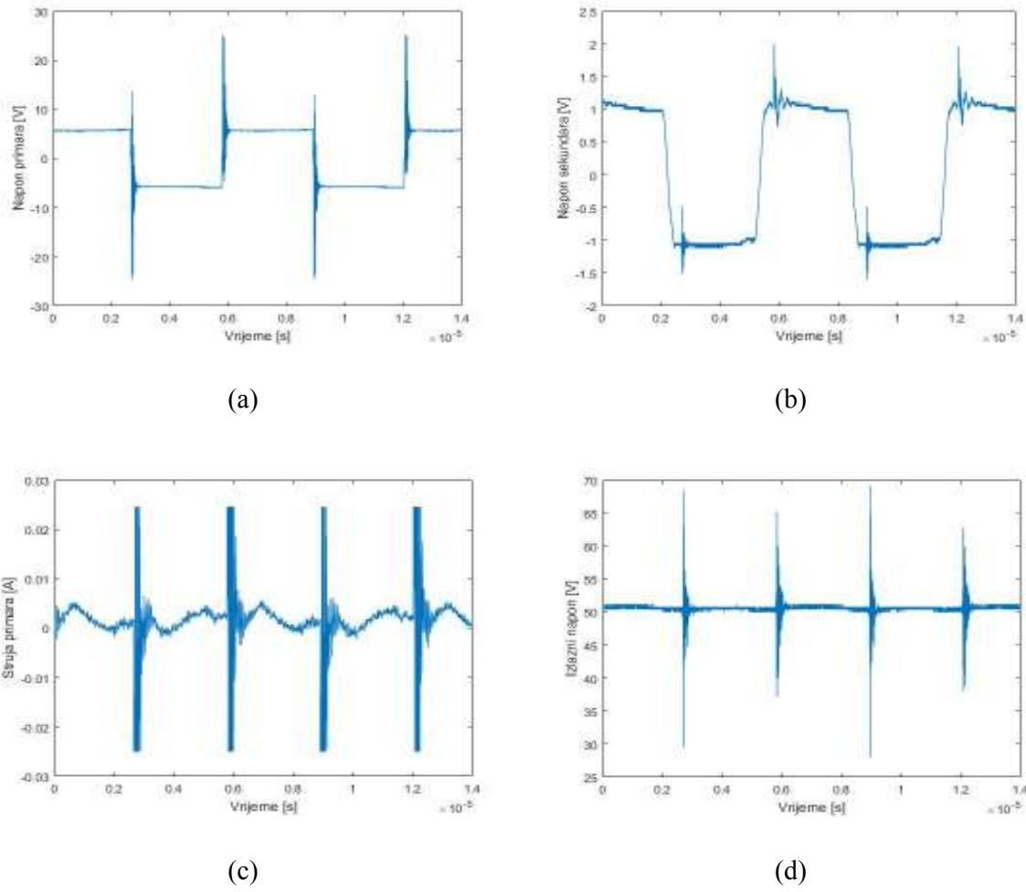
**Slika 4.5.** Valni oblici pri sklopnjoj frekvenciji od 160 kHz: a) napon primara, b) napon sekundara, c) struja primara, d) izlazni napon.
