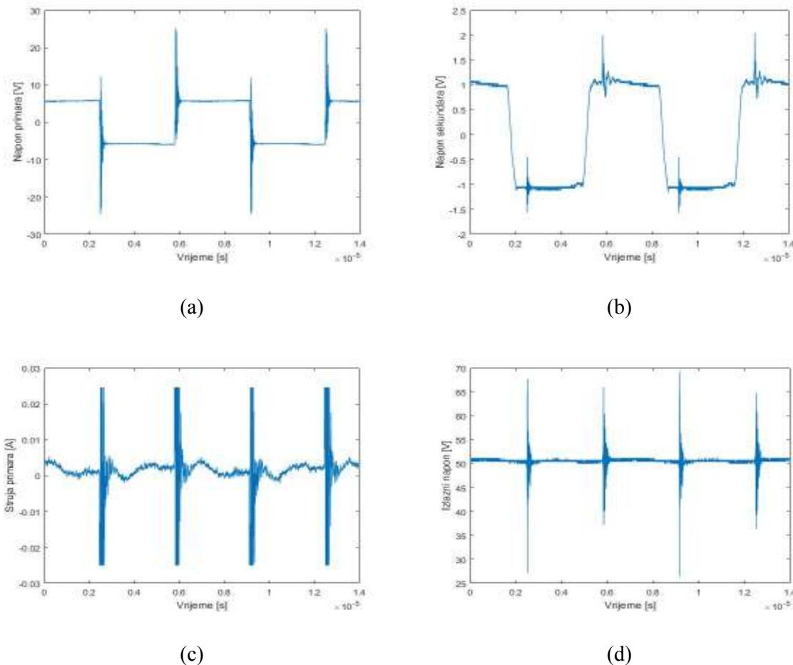
**Slika 4.4.** Valni oblici pri sklopnjoj frekvenciji od 150 kHz: a) napon primara, b) napon sekundara, c) struja primara, d) izlazni napon.
