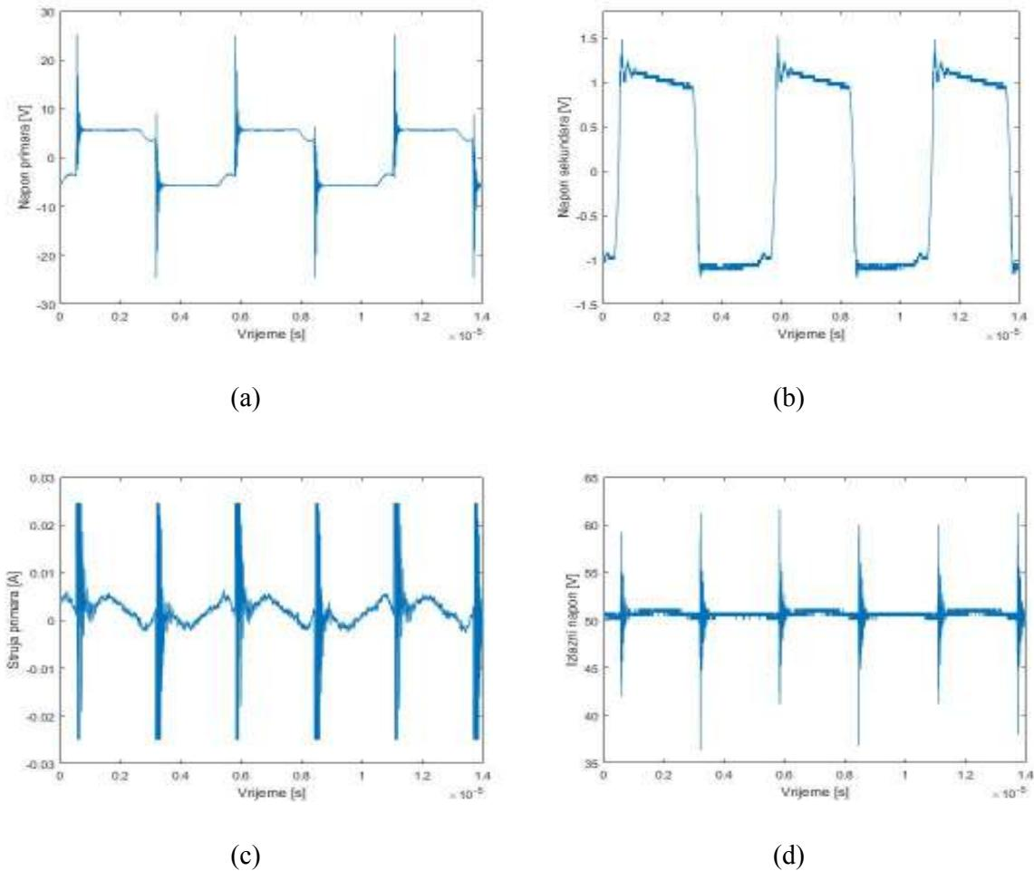
**Slika 4.8.** Valni oblici pri sklopnjoj frekvenciji od 190 kHz: a) napon primara, b) napon sekundara, c) struja primara, d) izlazni napon.
