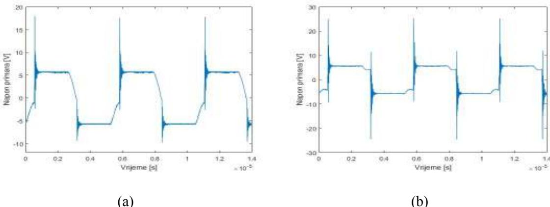
**Slika 4.14.** Napon primara na rezonantnoj frekvenciji od 190 kHz: a) bez opterećenja, b) s opterećenjem.
