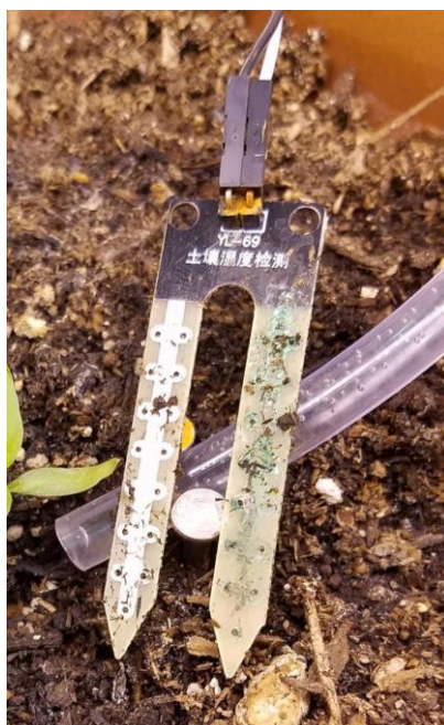
Slika 2.15. – prikaz oksidiranih elektroda rezistivnog senzora [21]
