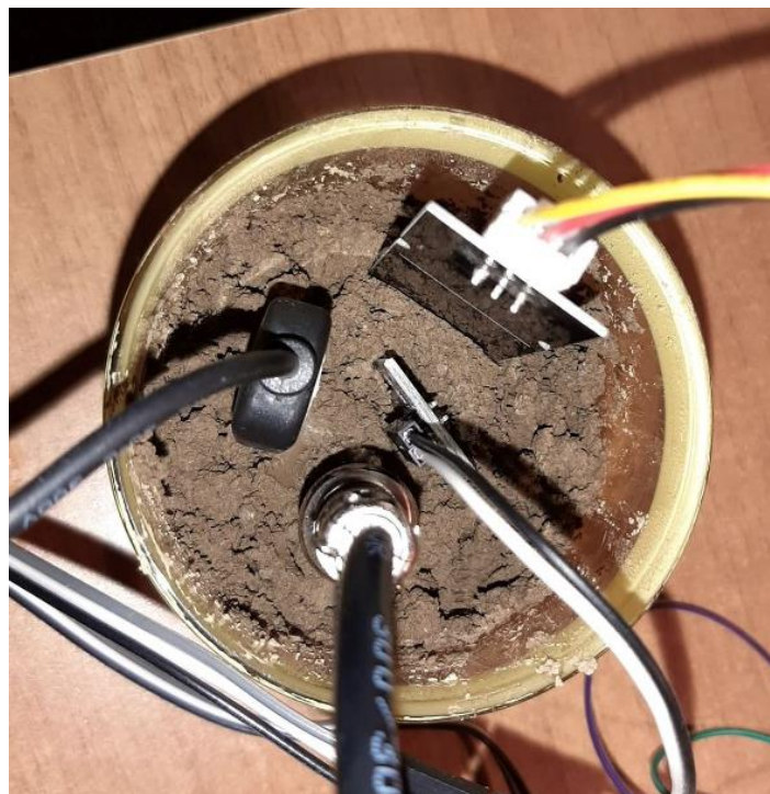
Slika 4.2. – Prikaz senzora uronjenih u zemlju prilikom testiranja
