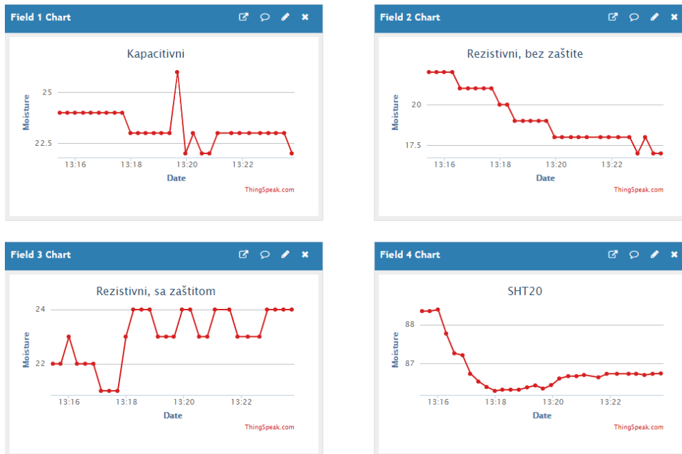
Slika 4.7. – Vrijednosti sa senzora za crnicu za 25% referentnu vlažnost
