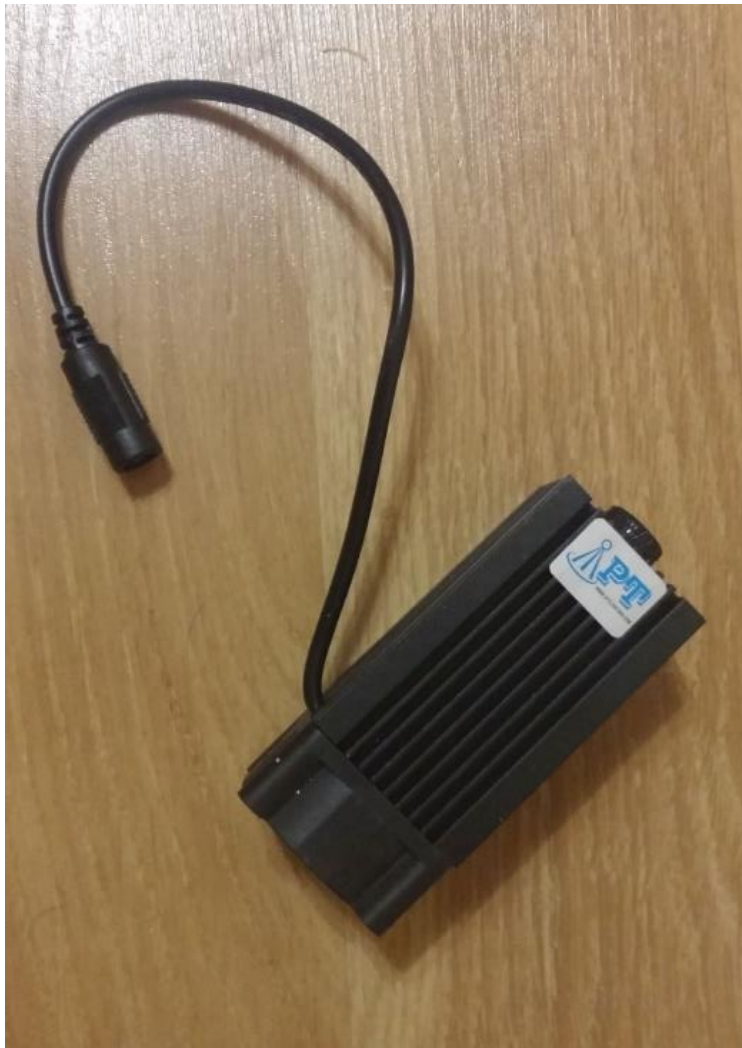
Slika 3.10: Laser 2500 mW, 445 nm
