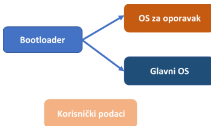
Slika 2.4. Korištenje jedne kopije za ažuriranje sustava
