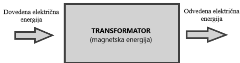
Slika 2.7. Pretvorba energije u transformatoru
