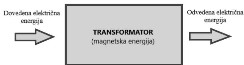
Slika 2.7. Pretvorba energije u transformatoru
