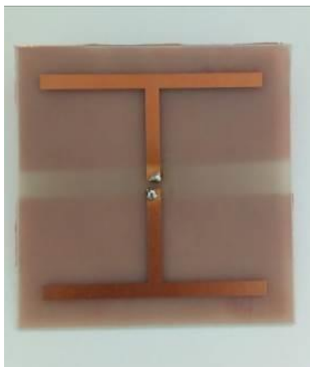
Slika 5.21. Tip-3 s tri bakarne trake
