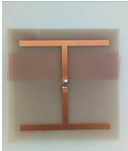
Slika 5.6. Tip-3 s jednom bakarnom trakom
