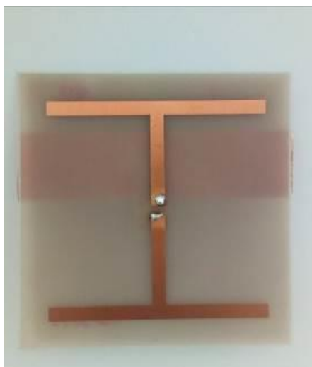
Slika 5.6. Tip-3 s jednom bakarnom trakom
