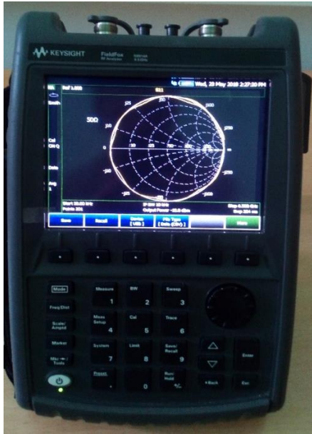
Slika 2.8. Analizator spektra Keysight N9914A
