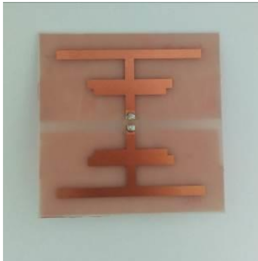
Slika 3.21. Tip-1 s četiri bakarne trake
