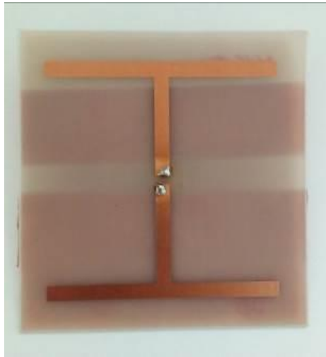
Slika 5.16. Tip-3 s tri bakarne trake
