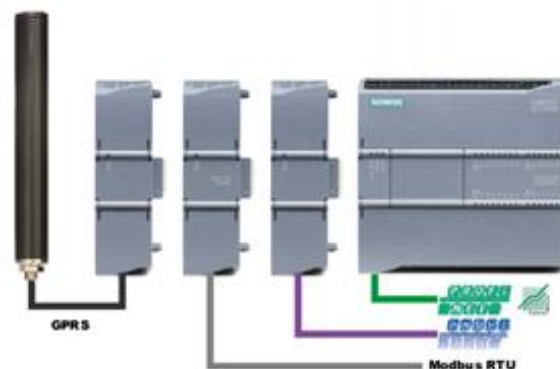
Slika 3.12. Mogućnosti komunikacije putem komunikacijskih modula [34]
