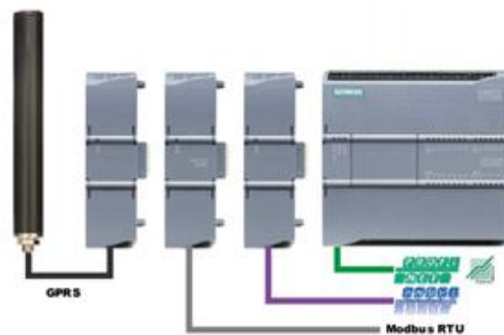
Slika 3.12. Mogućnosti komunikacije putem komunikacijskih modula [34]
