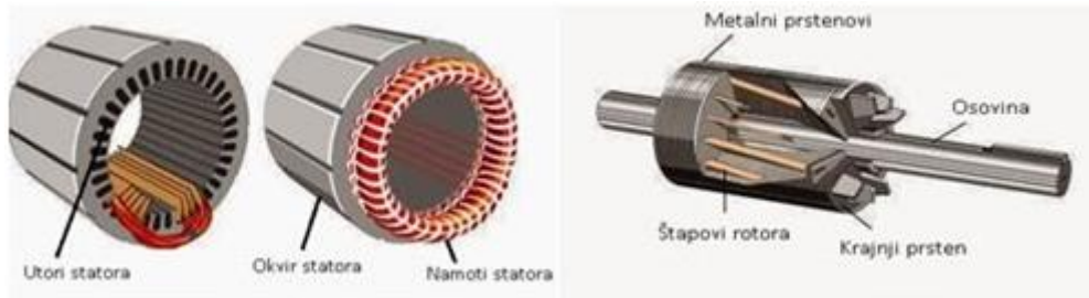
Slika 3.1. Stator i rotor asinkronog motora [21]
