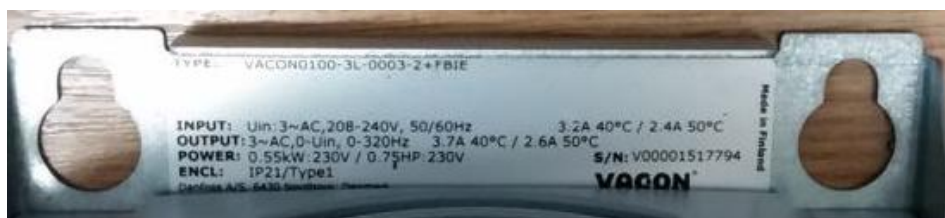
Slika 3.6. Nazivni podaci frekvencijskih pretvarača
