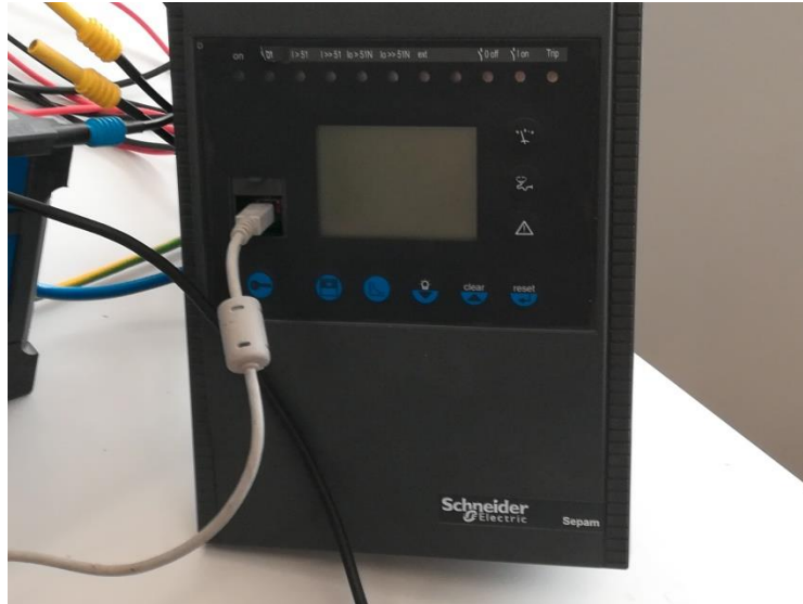
Slika 4.1 SEPAM M40 zaštitni uređaj
