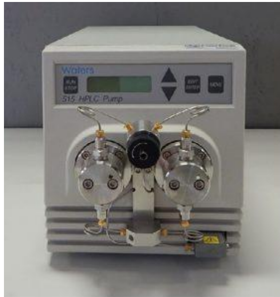
Slika 3.4. klipna pumpa za HPLC uređaj [8]
