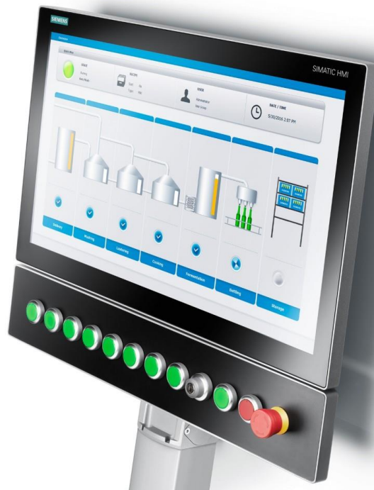
Sl. 2.1. Operatorski panel kao HMI uređaj [2]
