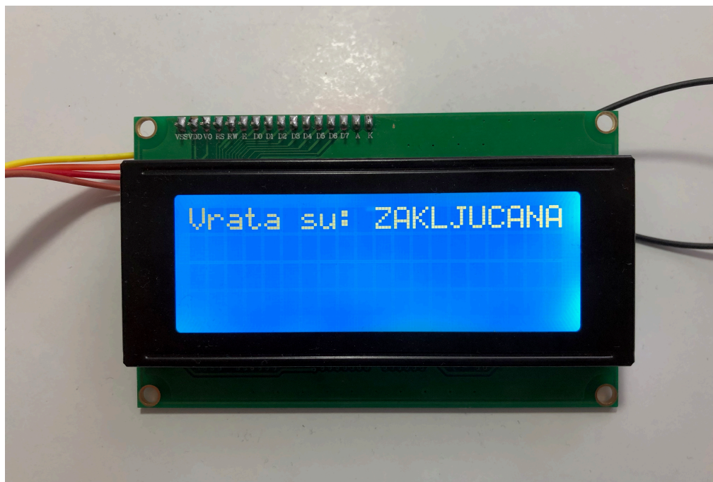
Slika 3.2.1. Prvo stanje elektronske brave (status za zaključana ulazna vrata)
