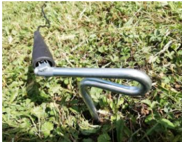
Slika 4.3 Pomoćna strujna sonda
