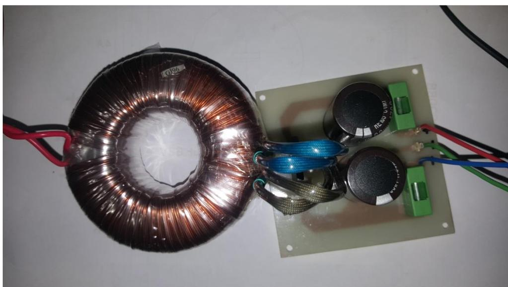
Slika 4.7. Ispravljač i transformator
