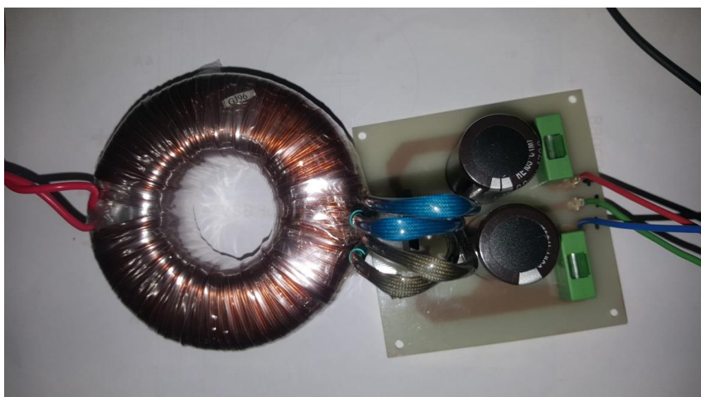
Slika 4.7. Ispravljač i transformator
